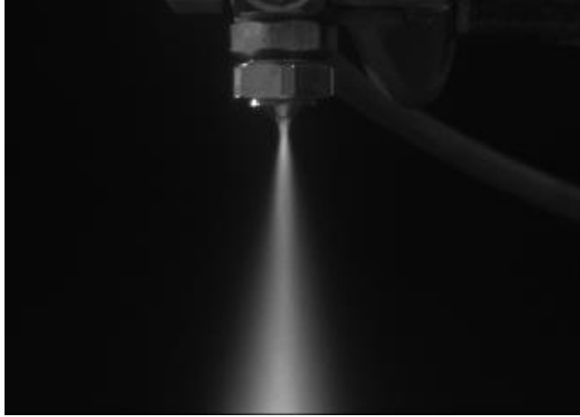
Şekil 4.50. ALR=0.206 için sprej görüntüsü ( Q_a=3.6 \text{ m}^3/\text{h} , Q_l=0.35 \text{ L/dk} , P_a=2.5 \text{ bar} , P_l=1.5 \text{ bar} )
