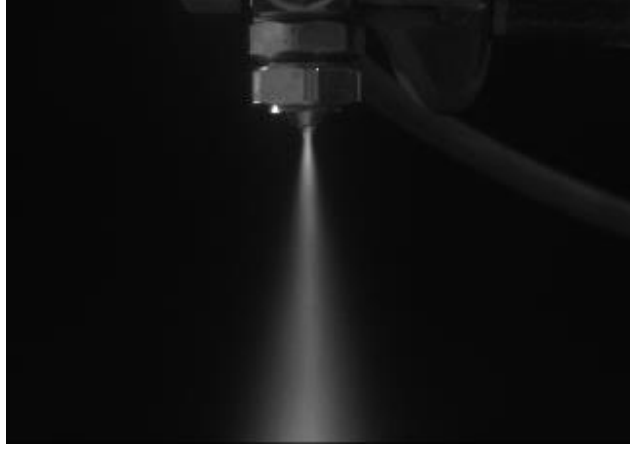
Şekil 4.49. ALR=0.166 için sprej görüntüsü ( Q_a=2.9 \text{ m}^3/\text{h} , Q_l=0.35 \text{ L/dk} , P_a=1.5 \text{ bar} , P_l=1.5 \text{ bar} )
