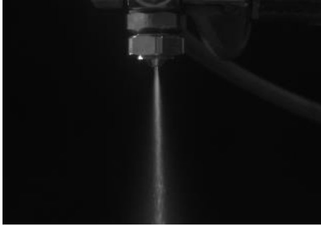
Şekil 4.46. ALR=0.084 için sprej görüntüsü ( Q_a=2.1 \text{ m}^3/\text{h} , Q_l=0.5 \text{ L/dk} , P_a=0.5 \text{ bar} , P_l=2.5 \text{ bar} )
