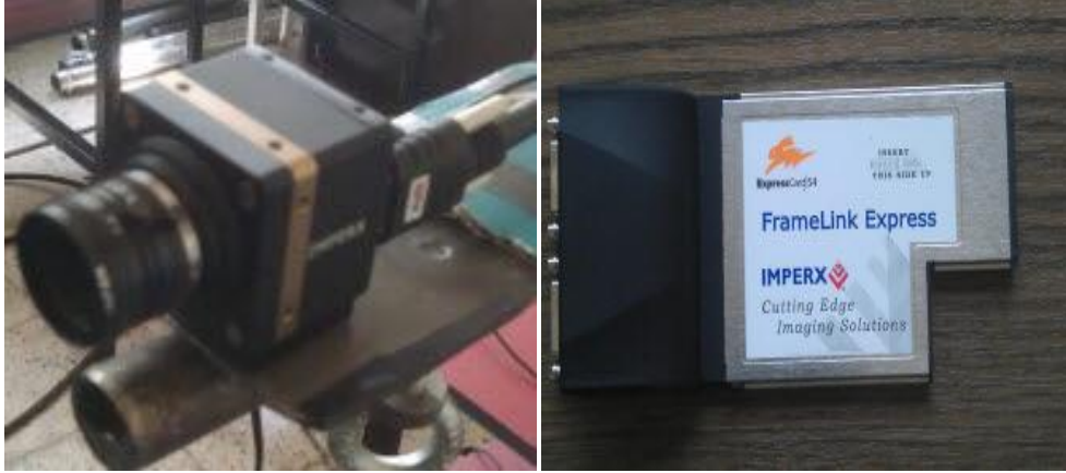
Şekil 3.5. IMPERX ICL B0620 CCD kamera ve Framelink
