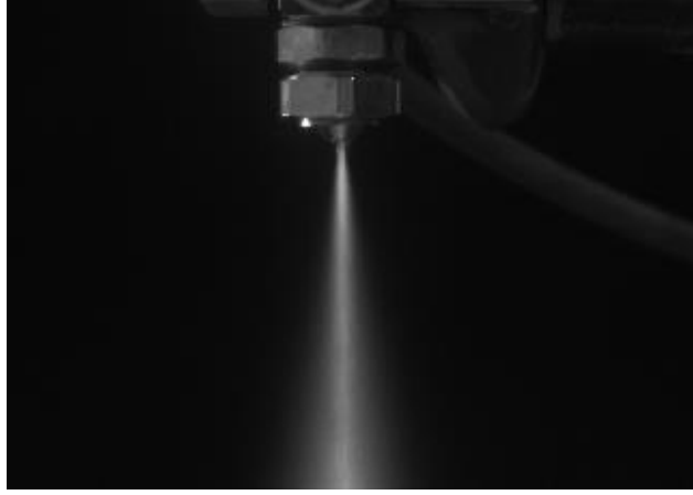
Şekil 4.47. ALR=0.116 için sprej görüntüsü ( Q_a=2.9 \text{ m}^3/\text{h} , Q_l=0.5 \text{ L/dk} , P_a=1.5 \text{ bar} , P_l=2.5 \text{ bar} )
