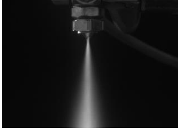
Şekil 4.48. ALR=0.144 için sprej görüntüsü ( Q_a=3.6 \text{ m}^3/\text{h} , Q_l=0.5 \text{ L/dk} , P_a=2.5 \text{ bar} , P_l=2.5 \text{ bar} )
