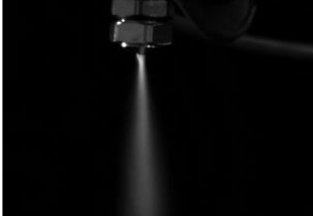
Şekil 4.53. ALR=0.36 için sprej görüntüsü ( Q_a=3.6 \text{ m}^3/\text{h} , Q_l=0.2 \text{ L/dk} , P_a=2.5 \text{ bar} , P_l=0.5 \text{ bar} )
