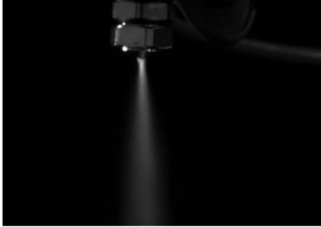
Şekil 4.52. ALR=0.29 için sprej görüntüsü ( Q_a=2.9 m 3 /h, Q_l=0.2 L/dk, P_a=1.5 bar, P_l=0.5 bar)
