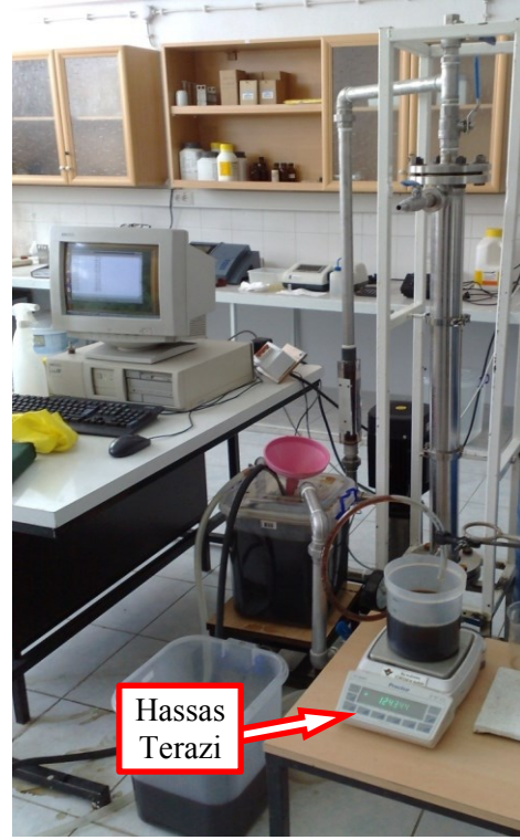
Şekil 3.6. Zeytin karasuyunun ön arıtımı amacıyla kullanılan mikrofiltrasyon ünitesi şematik görünümü ve fotoğrafı
