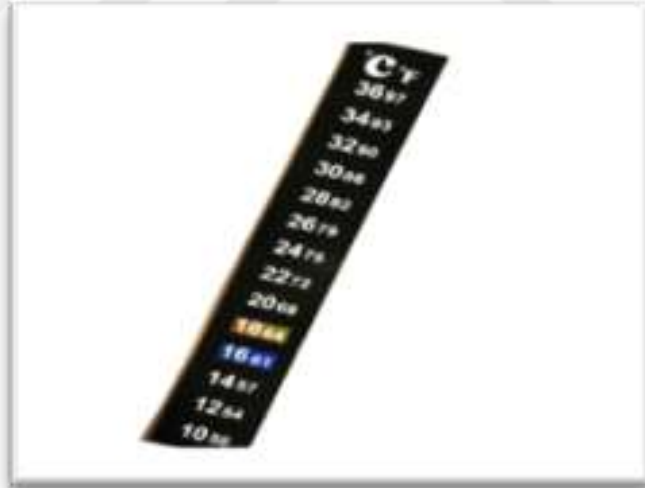
Şekil 2.5. Sıvı kristal termometre.
