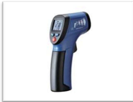
Şekil 2.7. İnfrared (kızılaltı) termometre.
