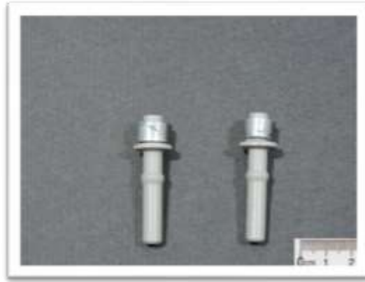
Şekil 4.3. Uygulamada kullanılan tekyönlü (simplex) konektör.
