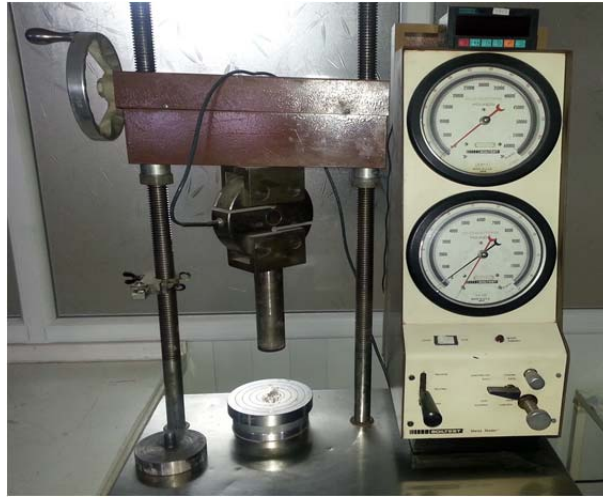
Şekil 3.11. Serbest basınç mukavemeti deneylerinde kullanılan SoilTest cihazı
