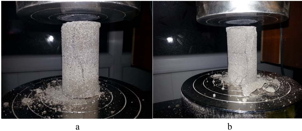
Şekil 4.5. POL 1 numunelerinin kırılması ait iki örnek
