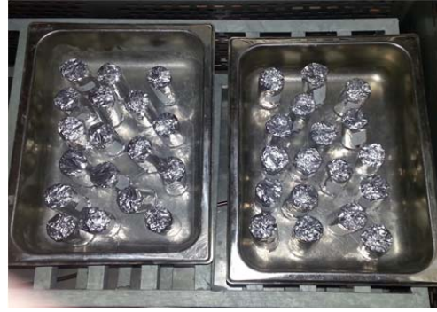
Şekil 3.12. Donma-çözülme cihazında bekletilen alüminyum folyo içerisindeki numuneler
