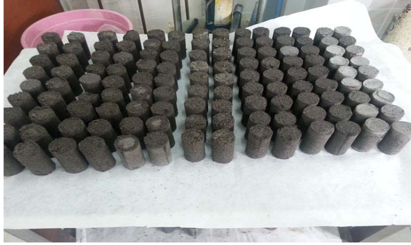
Şekil 3.10. Kür odasında bekletilen numuneler
