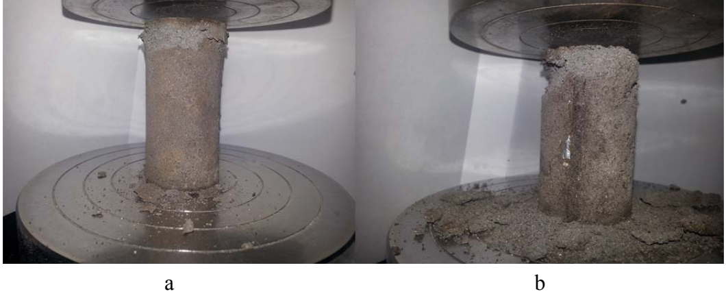
Şekil 4.6. POL 2 numunelerinin kırılması ait iki örnek (a) %20 POL 2 + %30 uçucu kül numunesi (b) %20 POL 2 + %20 uçucu kül numunesi
