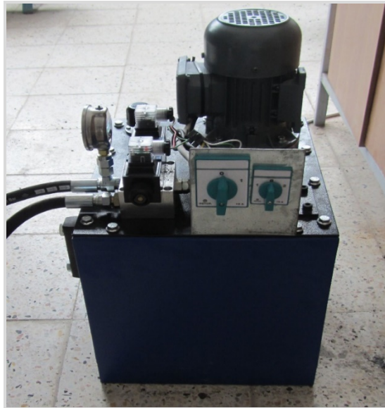
Şekil 3.10. Hidrolik pompa kontrol ünitesi
