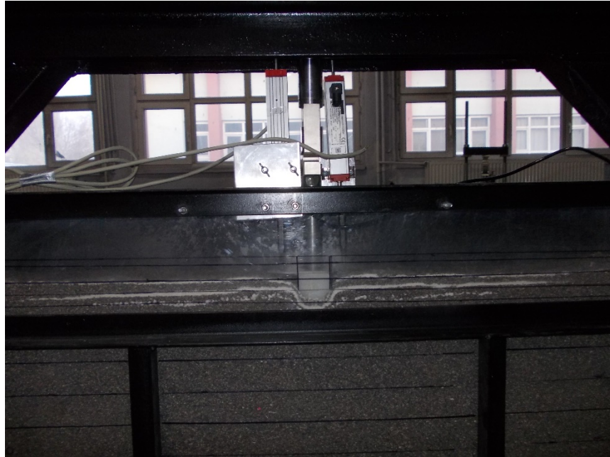
Şekil 4.3. Donatısız deney sonucu meydana gelen göçme
