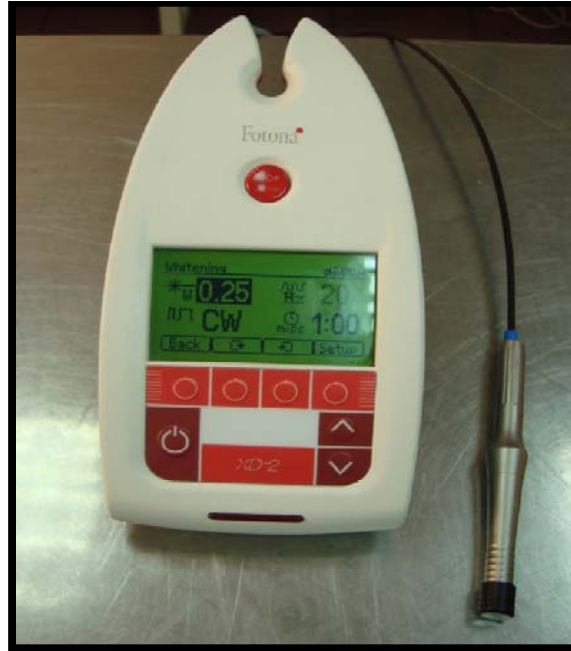
Şekil 3.2 Fotona XD2 lazer cihazı ve R24-B el aleti.
