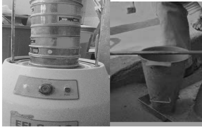
Şekil 3.2. Elekler ve çökme hunisi
