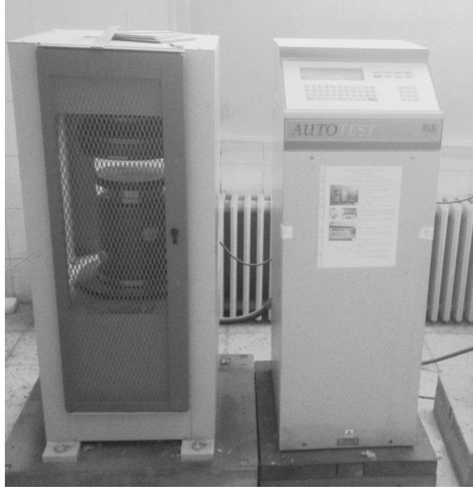
Şekil 3.5. Beton pres aleti
