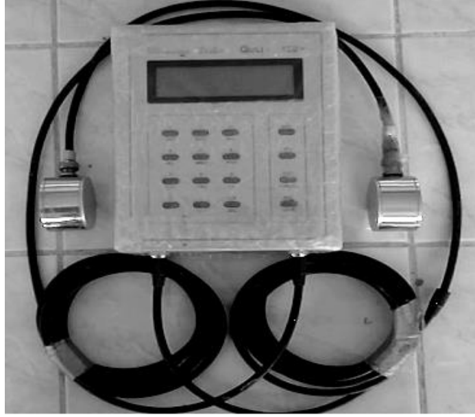
Şekil 3.6. Ultrases hızı ölçüm cihazı
