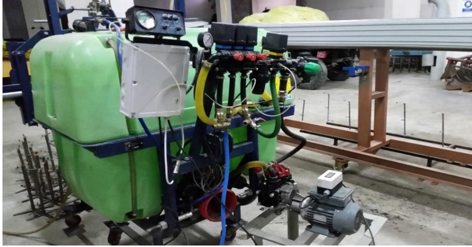
Şekil 5. Pülverizatör ve redüktörlü pompa
