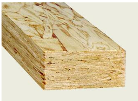
Şekil 1.1. Laminated Strand Lumber(LSL) örnek
