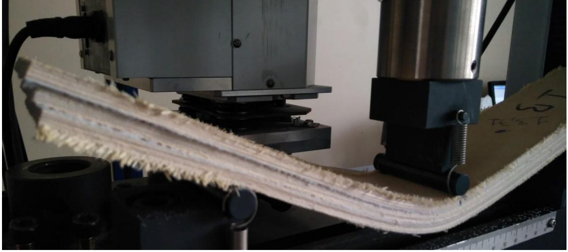
Şekil 3.4. 1B numunenin eğme deneyi esnasında deformasyon davranışı
