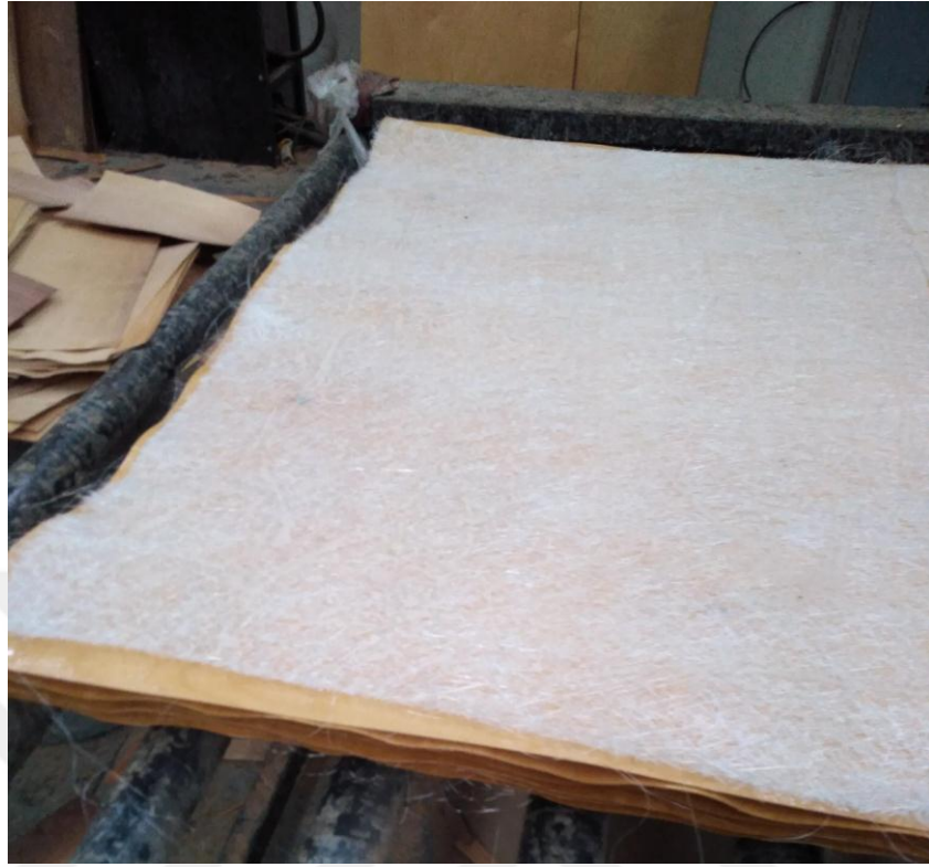
Şekil 2.7. El yatırması yöntemiyle cam elyafların tabakalar arasına yerleştirilmesi
