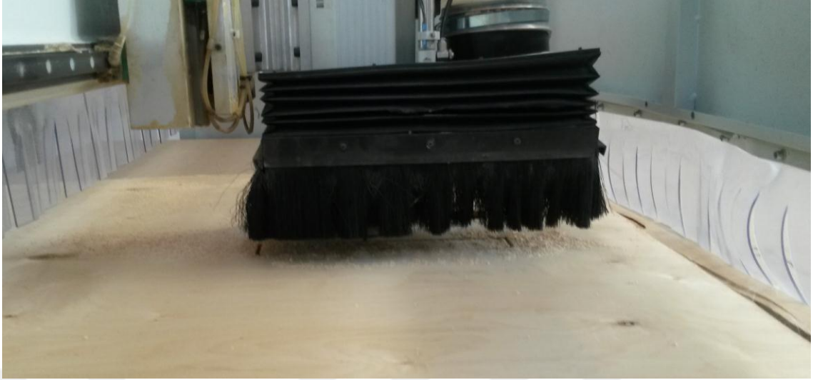
Şekil 2.9. Dik işleme tezgahında deney numunelerinin standartlara uygun olarak kesilmesi
