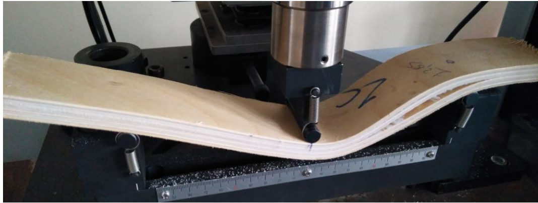
Şekil 3.5. Cam elyaf takviyeli numunenin eğme deneyi esnasında deformasyon davranışı
