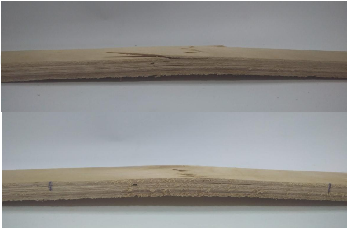
Şekil 3.6. Kontrol grubunun (K8) eğme deneyi sonrasında deformasyon davranışları
