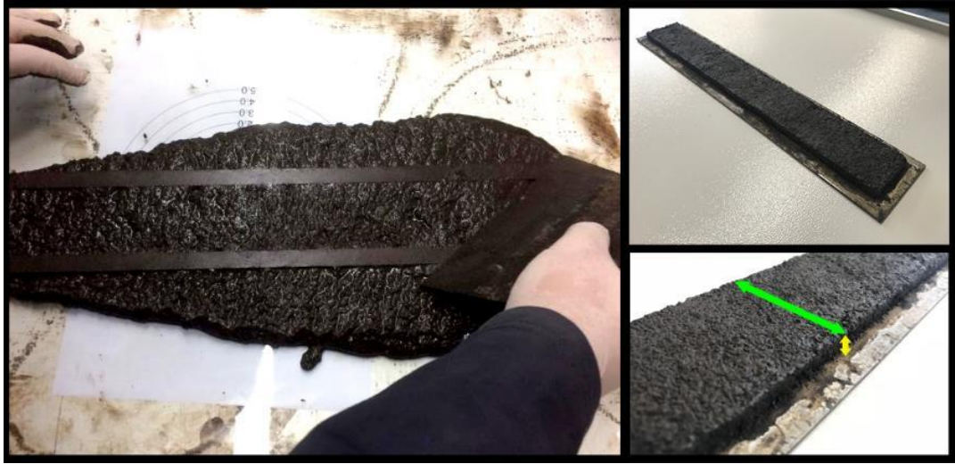
Şekil 5.15. Tekerlek İzi Numunesi Üretimi
