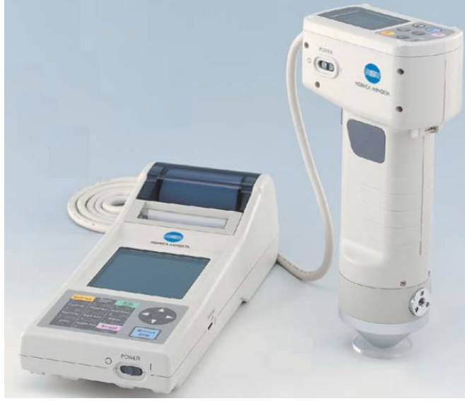
Şekil 3.2. Konica Minolta Chroma Meter CR-400 cihazın genel görünümü
