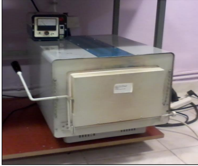
Şekil 3.7. Tavlama fırını (kristal büyütme araştırma laboratuvarı)
