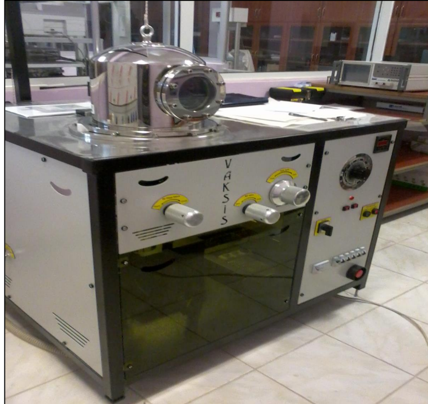
Şekil 3.6. Termal buharlaştırma yöntemiyle ince film kaplama sistemi
