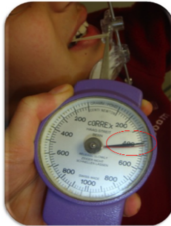
Şekil 3.4. Uygulanan kuvvetin 400 gr olarak ayarlanması
