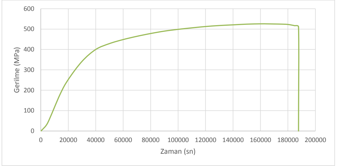
Şekil 4.4. AA 2024 alüminyum alaşımının %3,5 NaCl ortamındaki SSRT test sonucu
