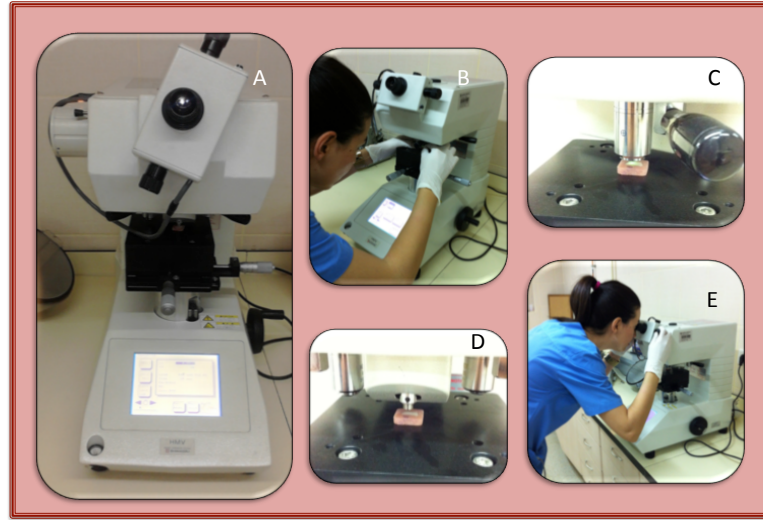
Şekil 3.3.1. Mine yüzeylerinin mikrosertlik ölçümleri
