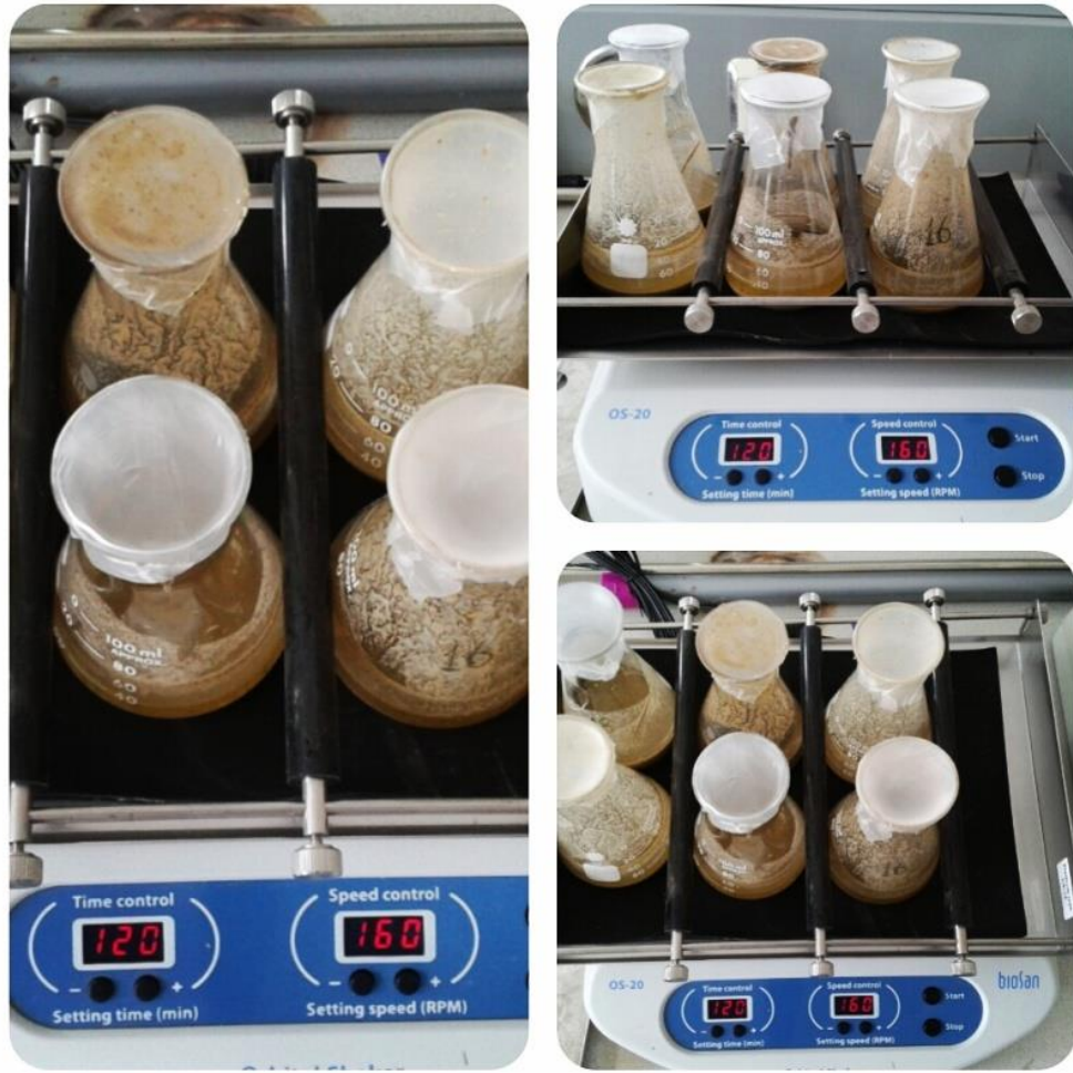
Şekil 3.9. Sedimentlerin ICP-OES ölçümleri için hazırlanma aşamalarından çalkalama işlemi (dakikadaki tur hızı 160'a, süre ise 120 dk'ya ayarlandı)
