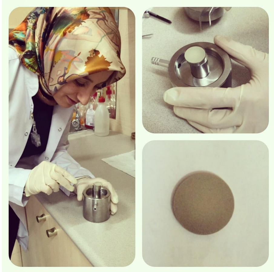
Şekil 3.12. EDXRF ölçümleri için numunelerin hazırlanma süreci
