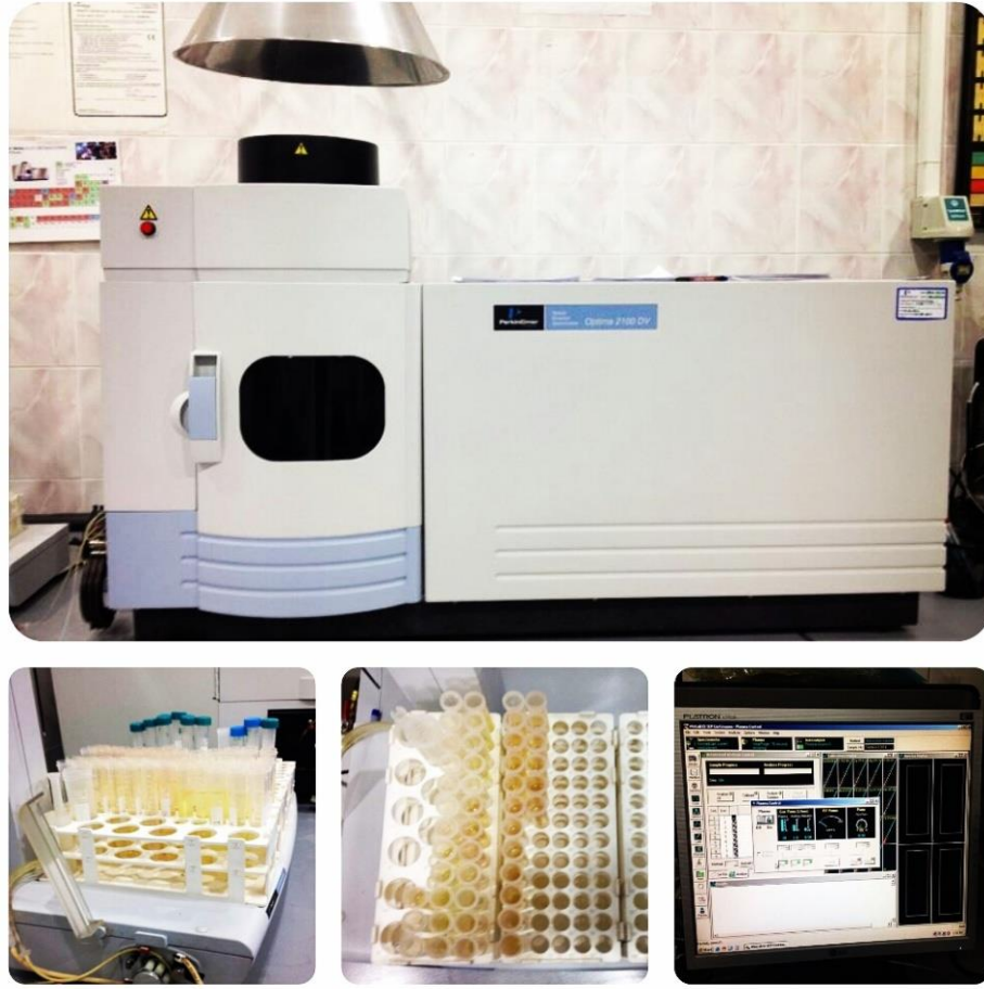
Şekil 3.11. Element analizinde kullanılan ICP-OES cihazı ve numunelerin analizine başlanması
