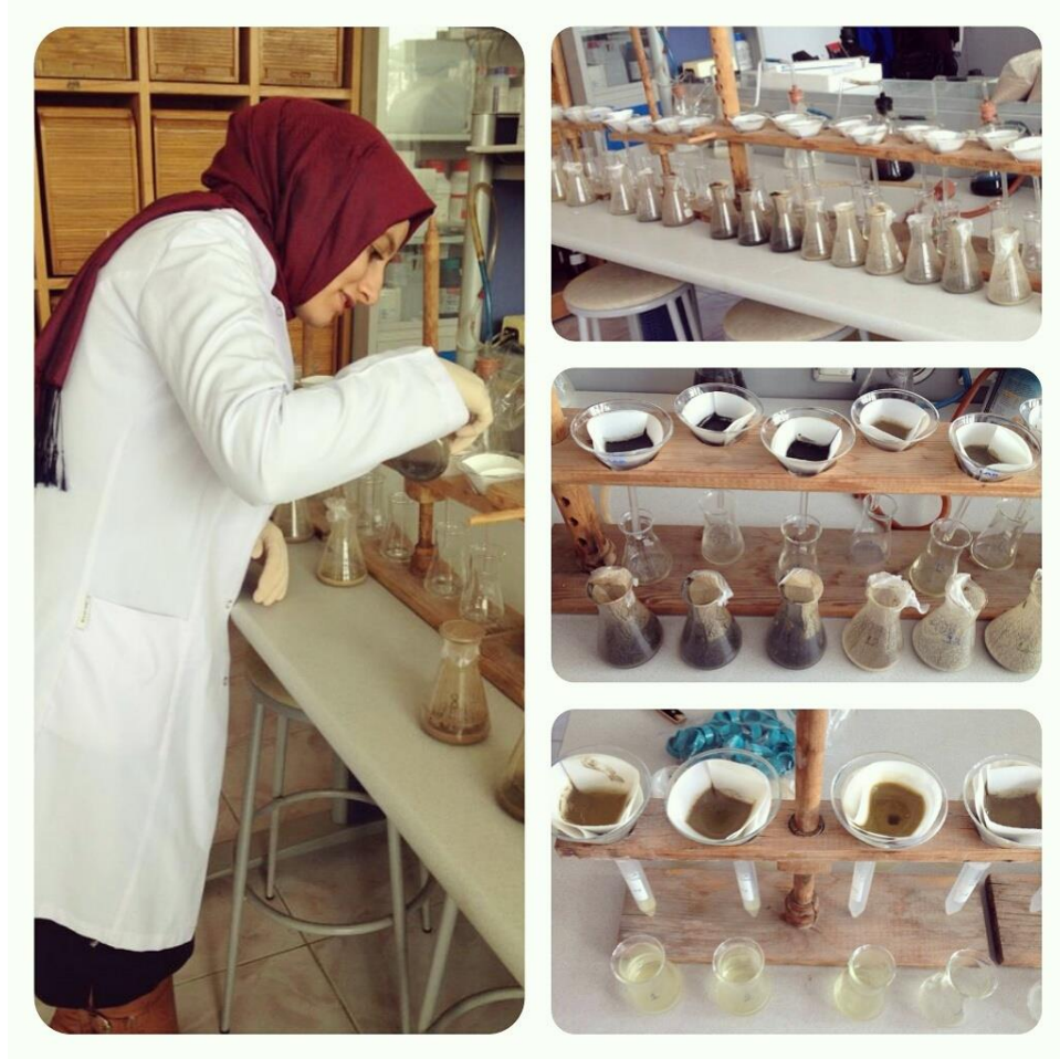
Şekil 3.10. Sediment numunelerinin ICP-OES ölçümleri için hazırlanma aşamalarından süzme işlemi
