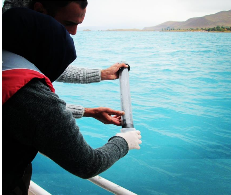
Şekil 3.6. Sediment numunelerinin numune kaplarına alınması
