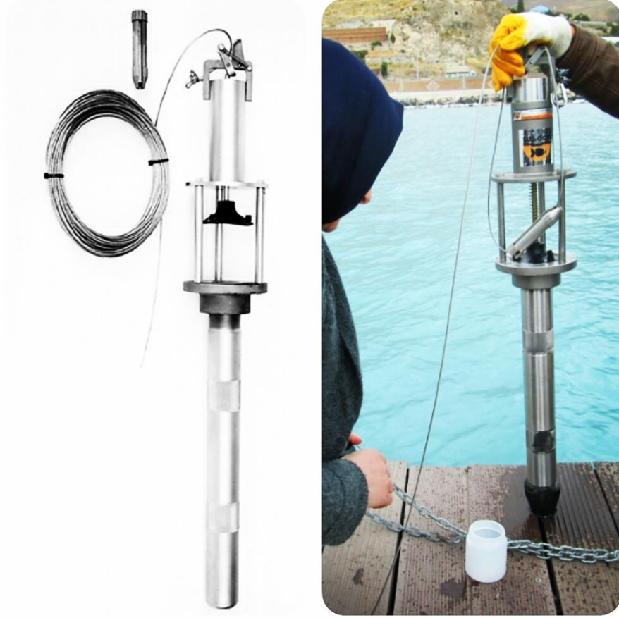
Şekil 3.4. Numuneleri almak için kullanılan K-B (Kajak-Brinkhurst) core cihazı ve cihazın kullanım deneme çalışmaları
