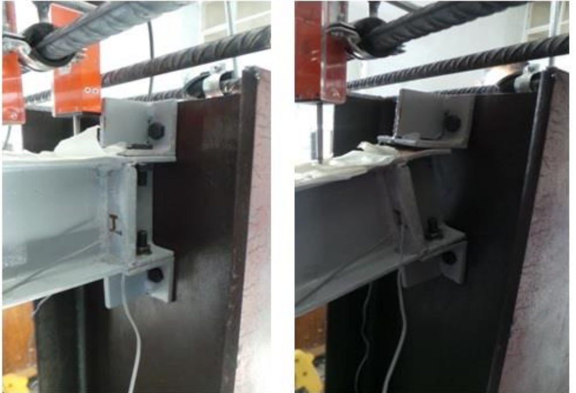
Şekil 4.12. Kiriş- kolon birleşiminin yükleme öncesi ve sonrası
