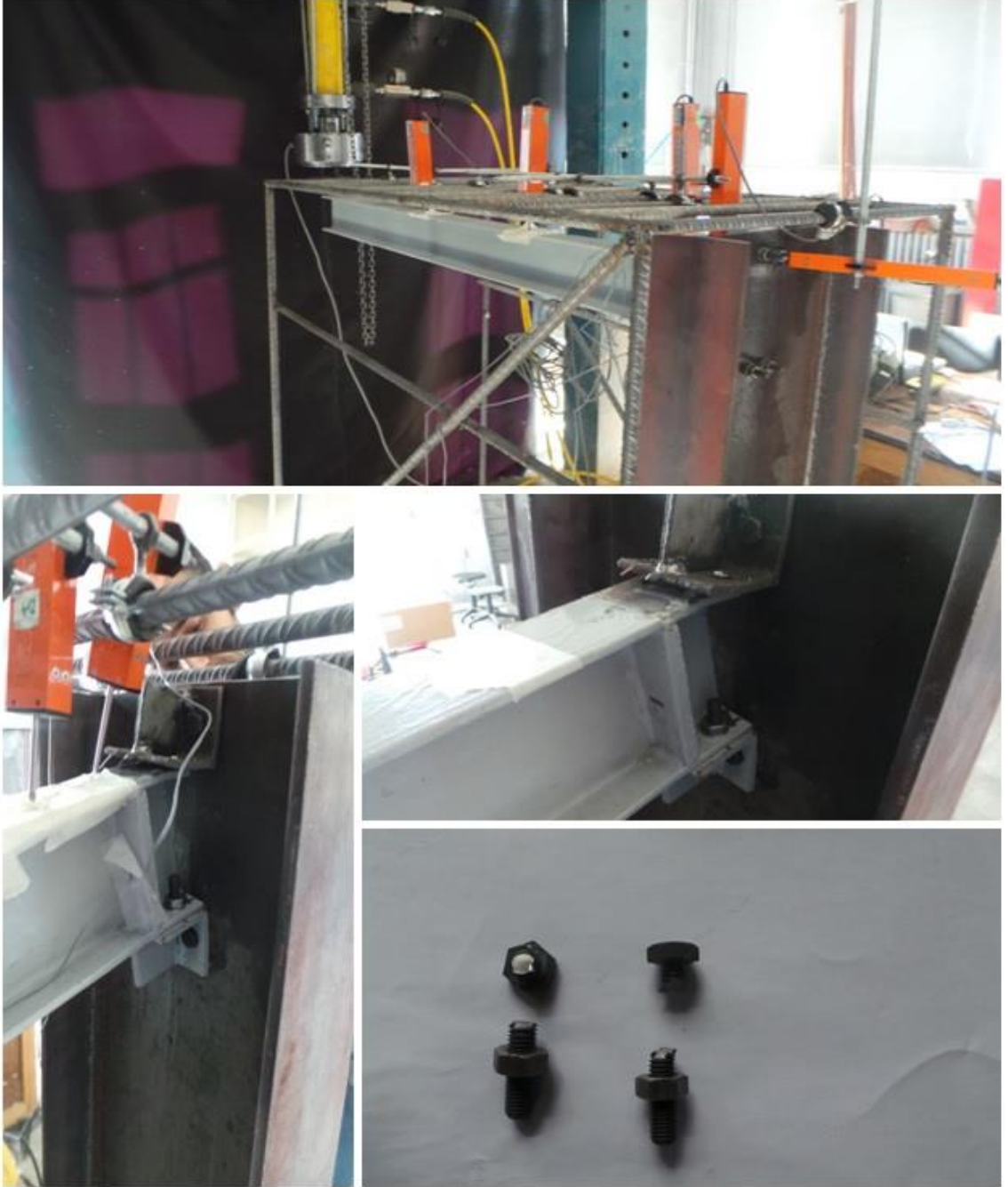
Şekil 4.5. Çelik kiriş-kolon ve bulonlarda meydana gelen kırılmalar
