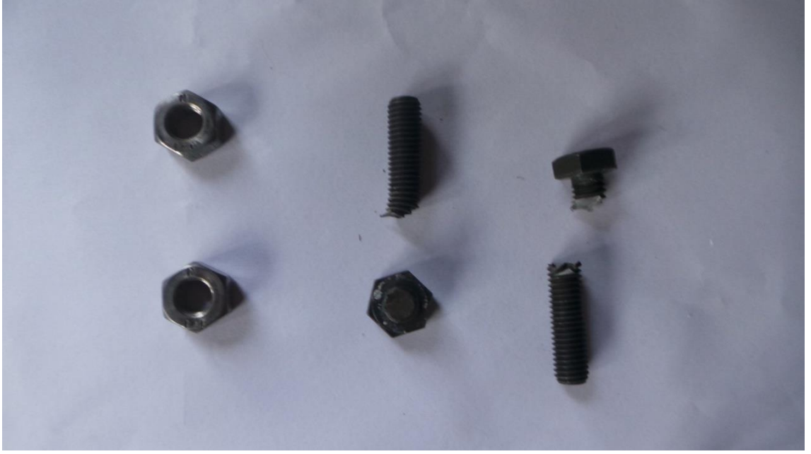
Şekil 4.13. Birleşimin üst bölgesinde meydana gelen cıvata kırılmaları
