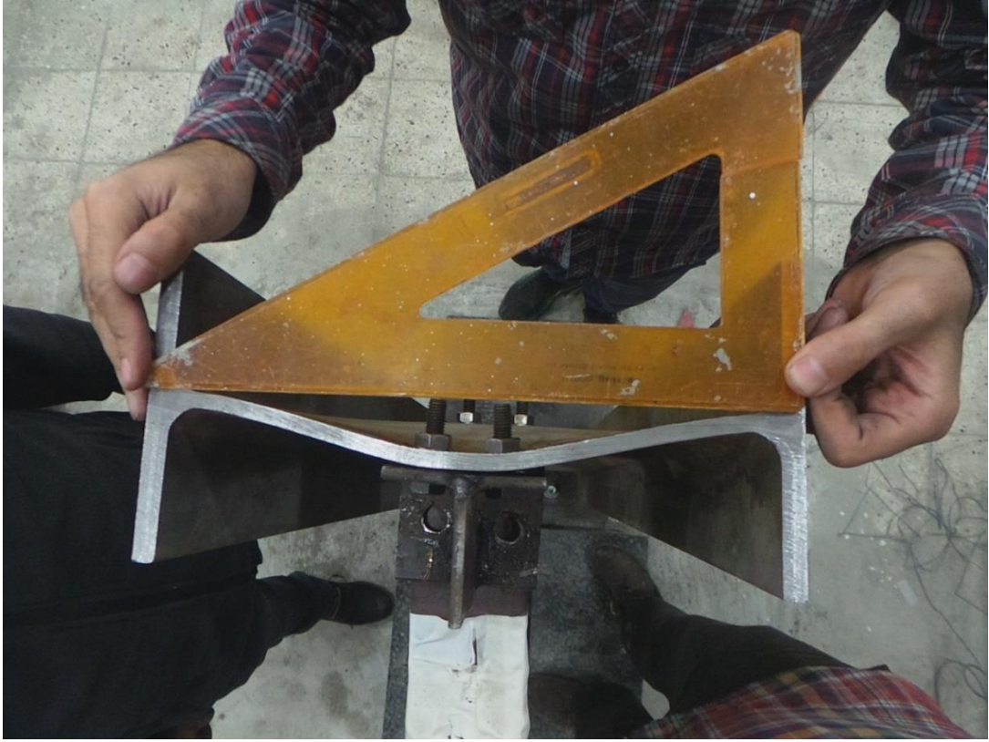
Şekil 4.38. Kolonda meydana gelen sehim
