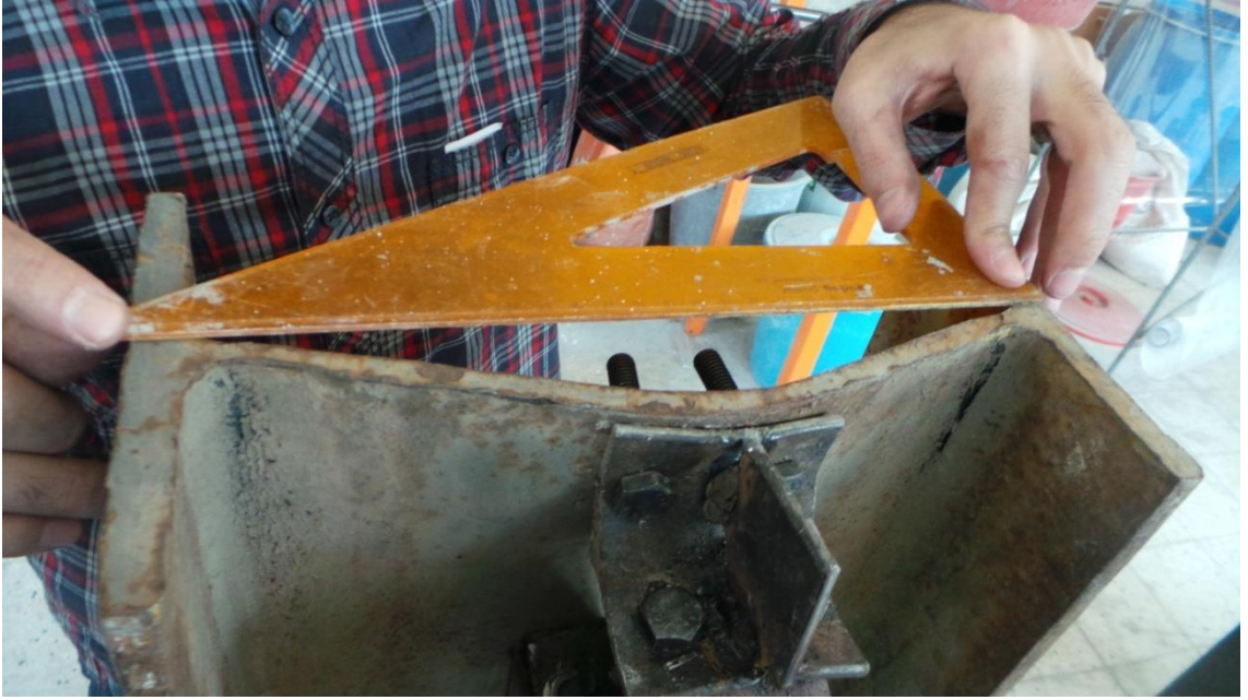
Şekil 4.55. Kolonda meydana gelen sehim
