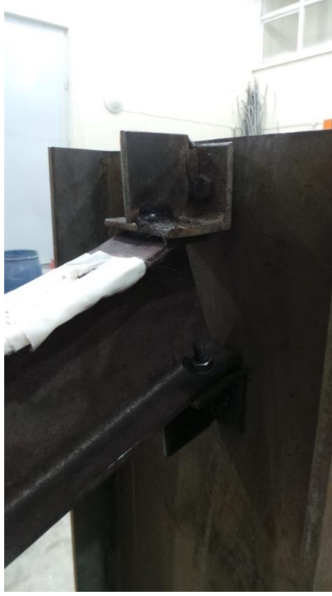
Şekil 4.36. Kiriş- kolon birleşiminin yükleme sonrası
