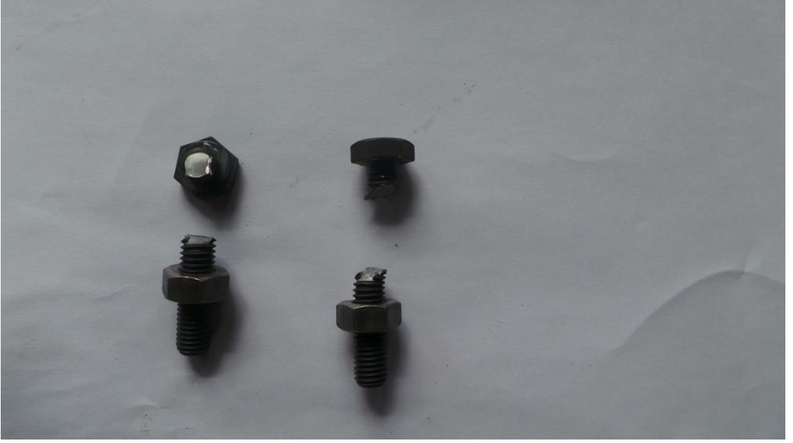
Şekil 4.28. Birleşimin üst bölgesinde meydana gelen cıvata kırılmaları
