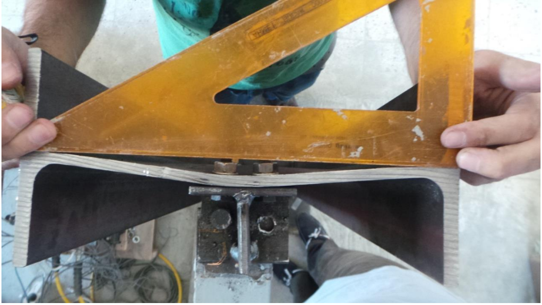
Şekil 4.6. Kolonda meydana gelen sehım gösterilmiştir
