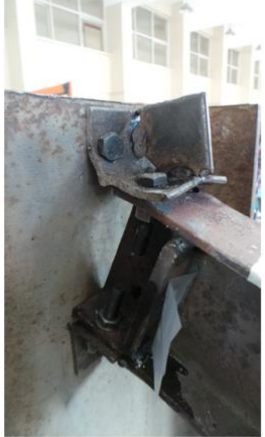
Şekil 4.54. Kiriş-kolon birleşiminin yükleme öncesi ve sonrası
