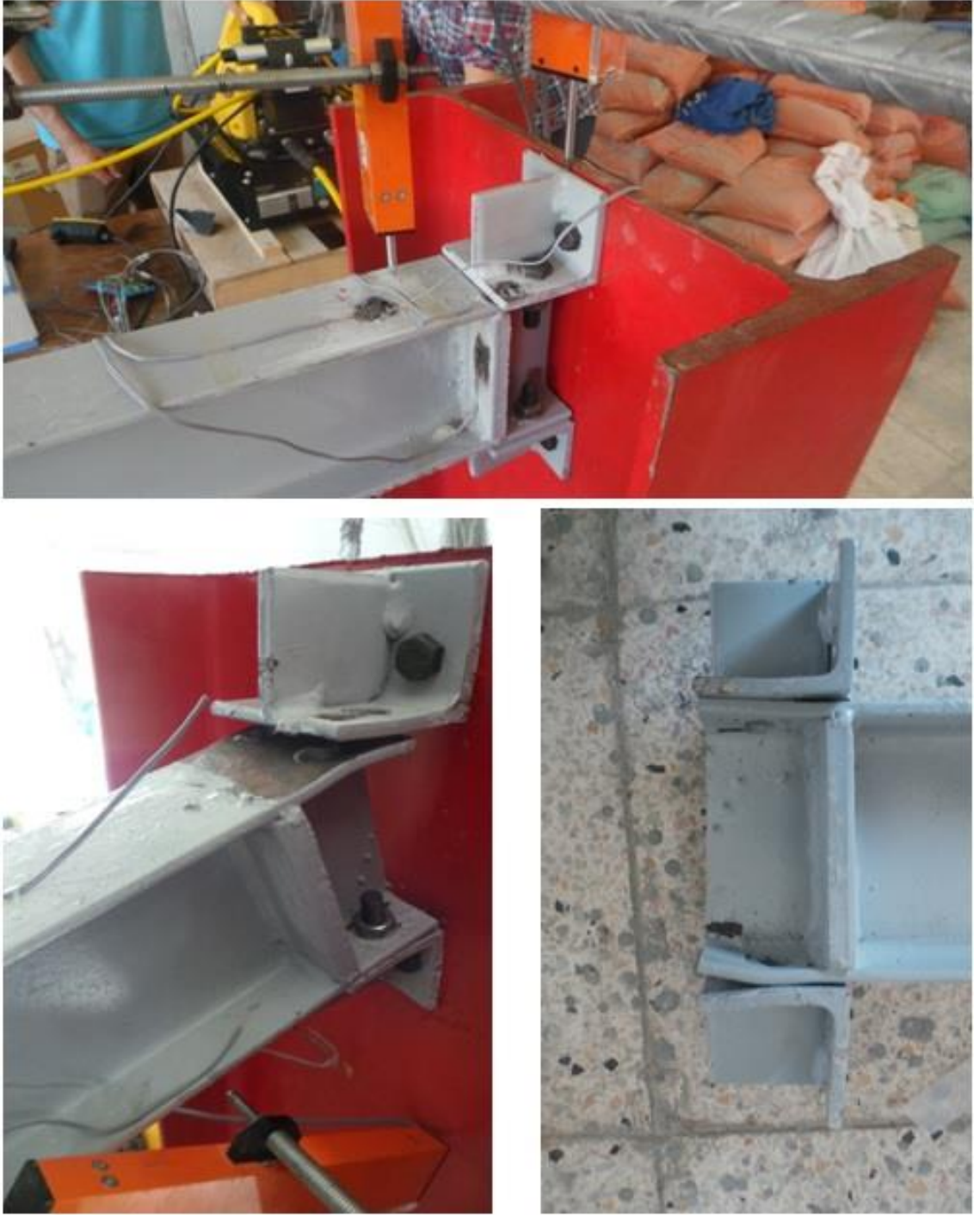
Şekil 4.27. Kiriş-kolon birleşiminin yükleme öncesi ve sonrası
