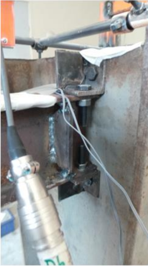
Şekil 4.54. Kiriş-kolon birleşiminin yükleme öncesi ve sonrası
