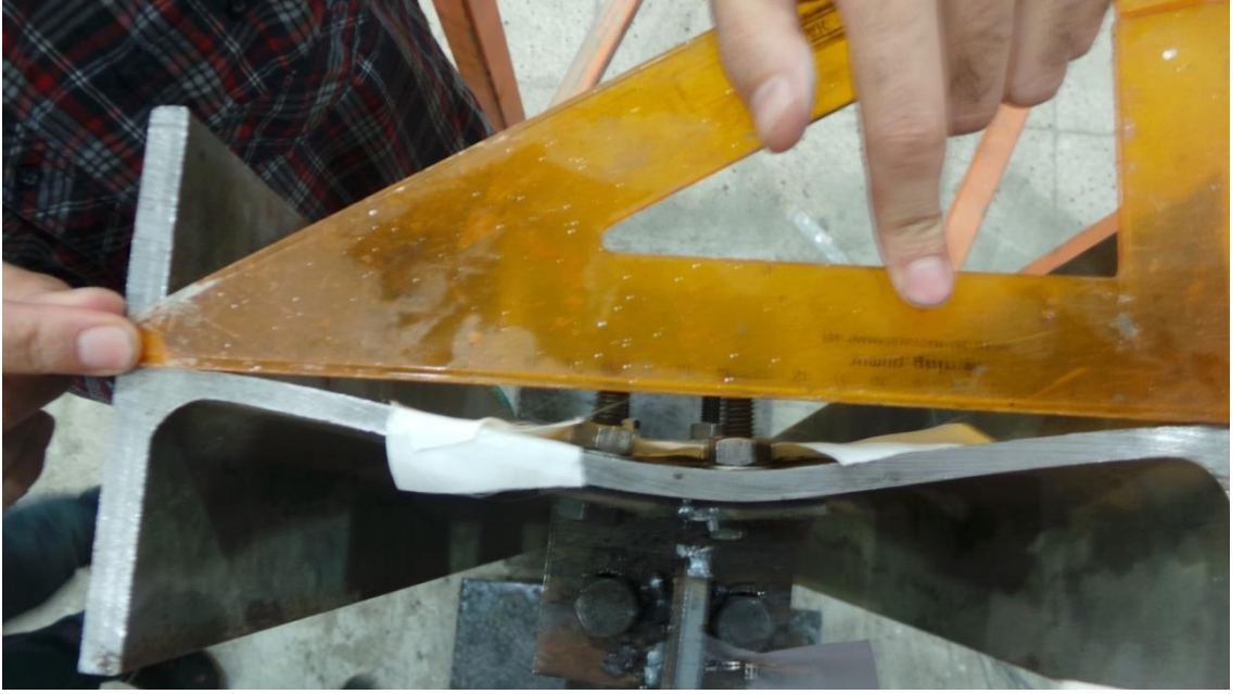
Şekil 4.47. Kolonda meydana gelen sehim
