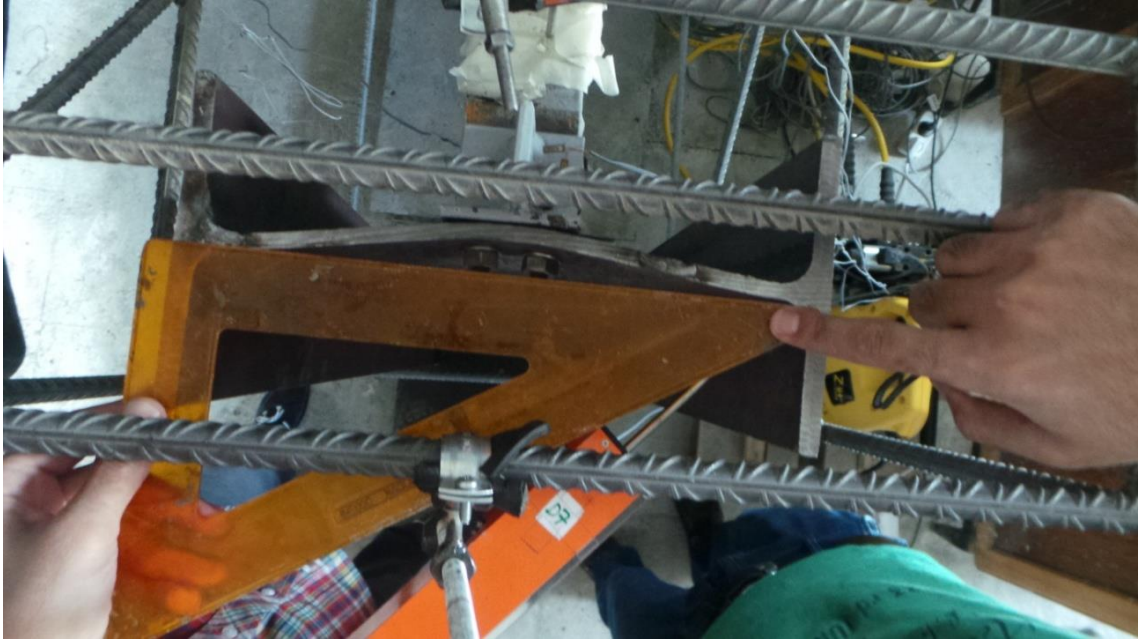
Şekil 4.14. Kolonda meydana gelen sehim
