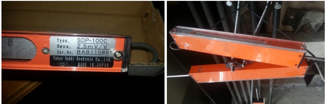
Şekil 3.1. Deformasyon cihazı (LVDT) dijital cihazın görüntüsü
