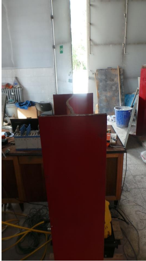
Şekil 4.29. Kolonda meydana gelen sehim
