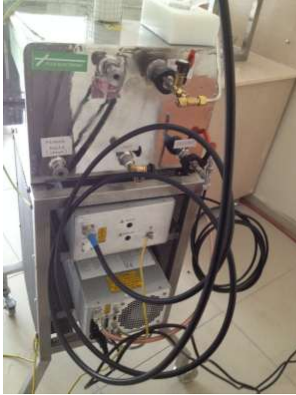
Şekil 3.6. Plazma Polimerizasyonu reaktörünün giriş ve çıkışları
