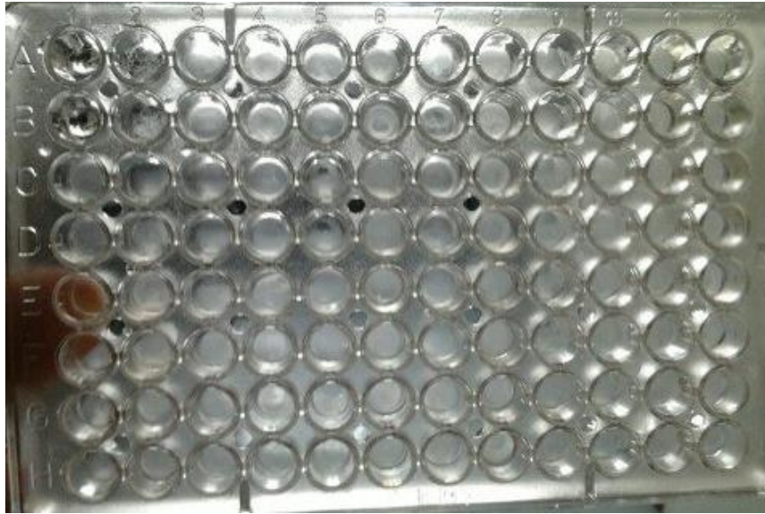
Şekil 3.2 Mikroplakta XTT indirgenmesi ile biyofilm varlığının test edilmesi yönteminde yıkama sonrasında kuyucuklardaki biyofilmin görünüşü (A1 ve B1 kuyucukları negatif kontrol).
