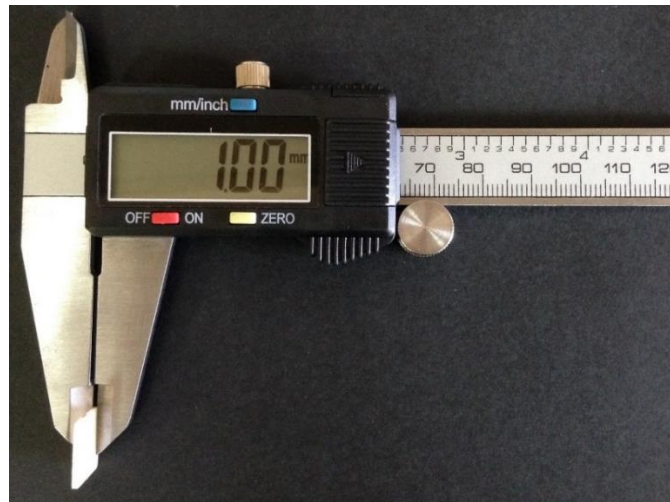
Şekil 3.2. Seramik kalınlıklarının ölçülmesi (1 mm)
