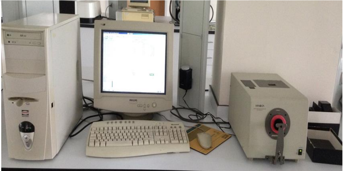
Şekil 3.8. Çalışmamızda seramik örneklerin renk analizinde kullanılan spektrofotometre.
