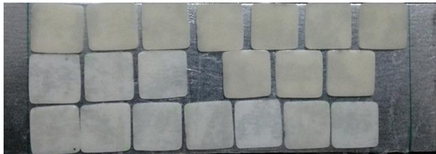
Şekil 3.10. Metal taşıyıcıya yerleştirilen seramik örnekler.
