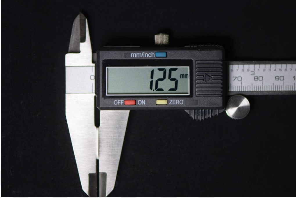
Şekil 3.3. Sinterizasyon işleminden önce Katana marka örneğin kalınlık kontrol ölçümü.
