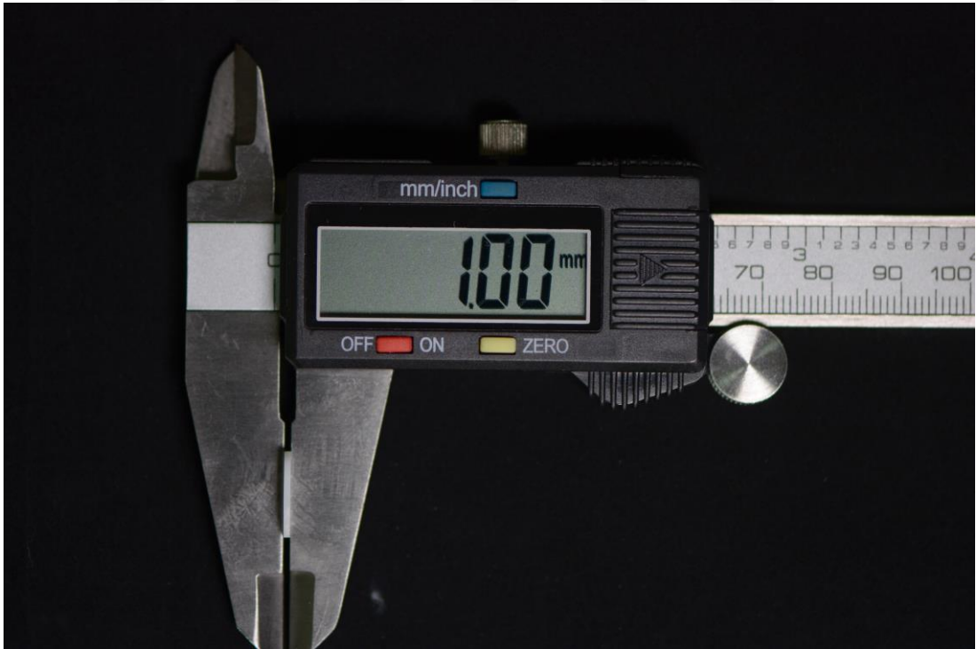
Şekil 3.10. Sinterizasyon sonrası kalınlık ölçümü
