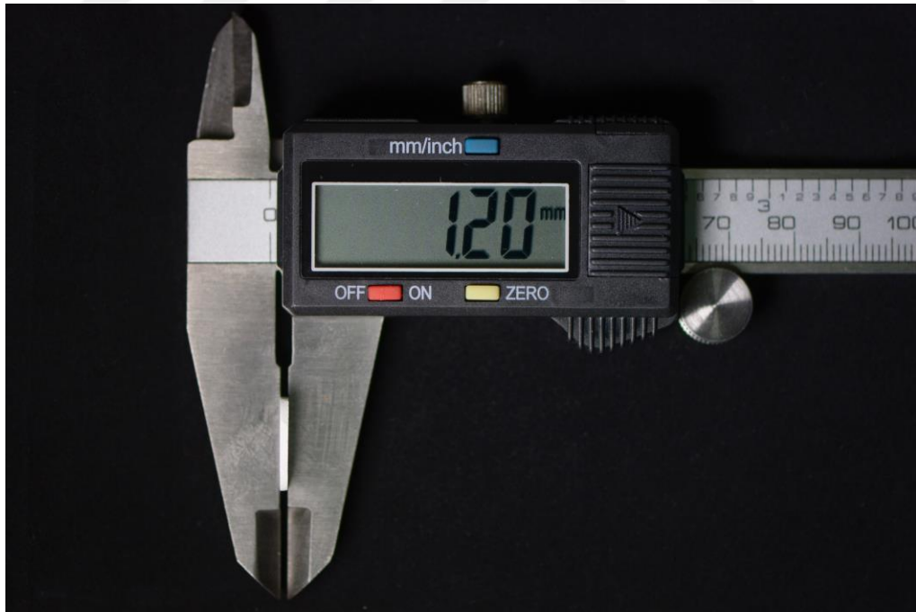
Şekil 3.4. Sinterizasyon işleminden önce White Peaks marka örneğin kalınlık kontrol ölçümü
