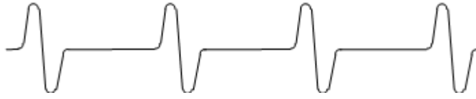
Şekil 3.19. Krank mili Sensöründen alınan sinyal biçimi
