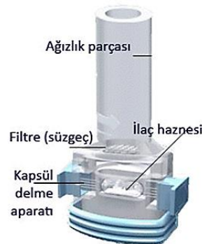
Şekil 2.10. Aerolizer® aygıtının parçaları (100).
