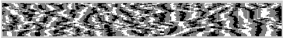
Şekil 3.10. İris imgesi özniteliklerinin Log-Gabor yöntemi kullanarak kodlaması
