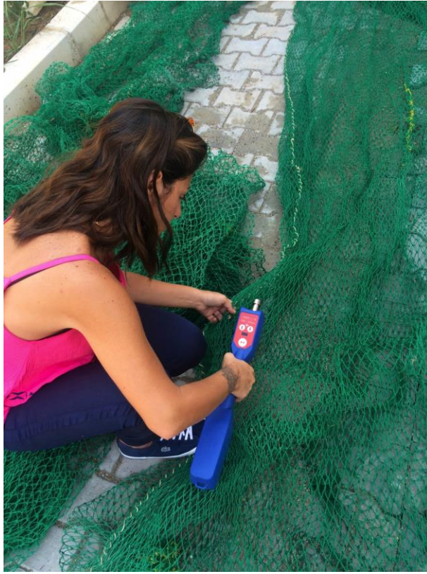
Şekil 3.8. Omega Mesh Gauge cihazı ile ağ gözlerinin ölçümü
