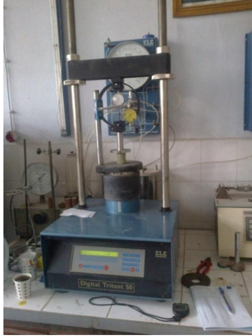
Şekil 3.12. Serbest basınç deneyi düzeneği
