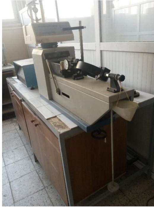
Şekil 3.13. Kesme kutusu deneyi aleti
