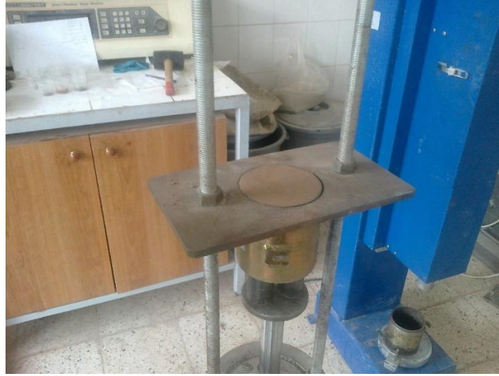
Şekil 3.11. Serbest basınç deneyi için numune alınması
