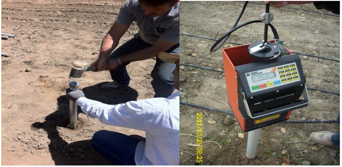
Şekil 3.14. Deneme alanına nötron borularının yerleştirilmesi ve Nötronmetre ile nem takibi işlemi
