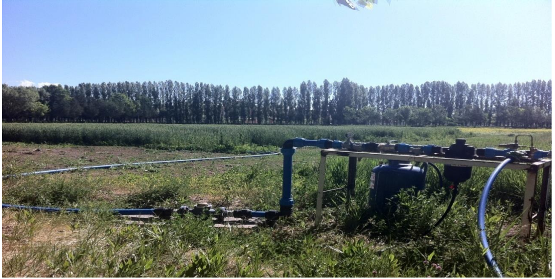
Şekil 3.17. Damla sulama sistemi bileşenleri (ana lateraller ve manometreler) genel görünüm
