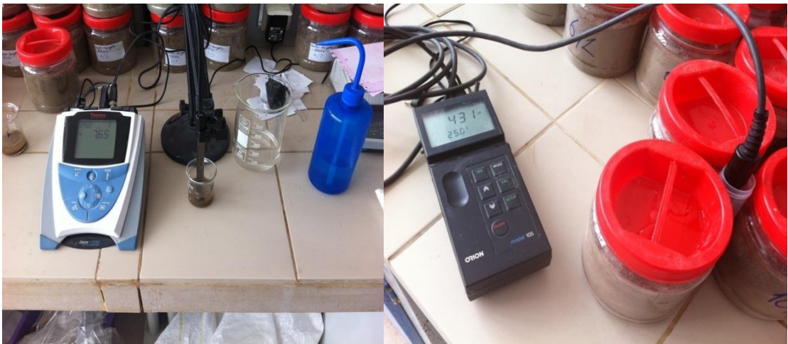
Şekil 3.6. pH metre ve EC metre ile toprakların pH ve EC analizinden görünüm
