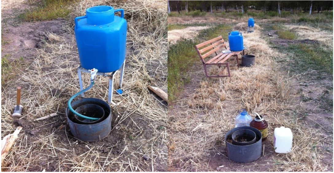
Şekil 3.5. Çift silindir sabit seviyeli infiltrometre ile arazide infiltrasyon ölçümünden görünüm
