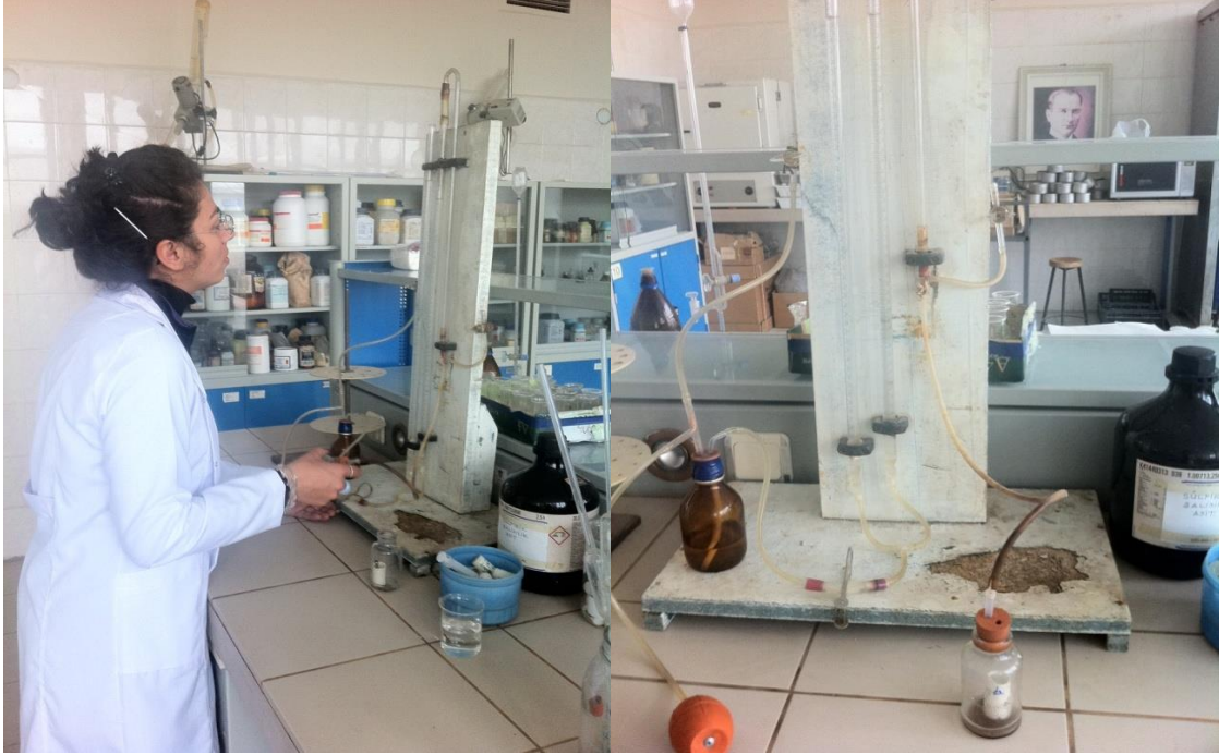
řekil 3.7. Toprakların kire ierikleri tayini iin kullanılan dzenek ve analizden grnm
