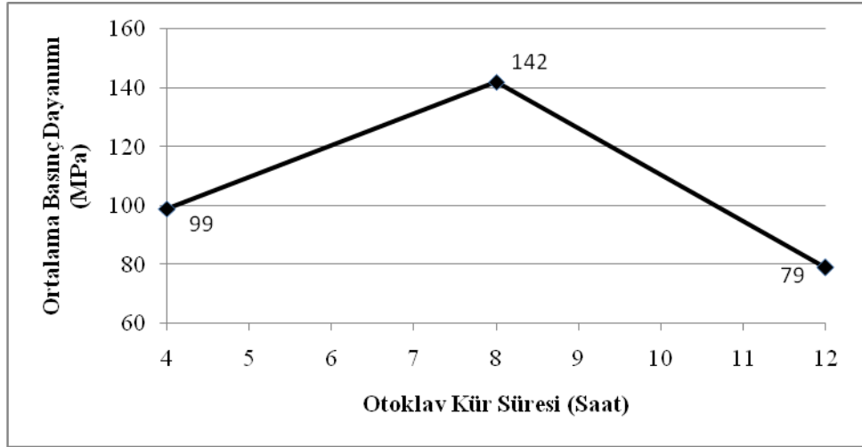
Şekil 4.3. Lifsiz RPB otoklav kürü basınç deney sonuçları
