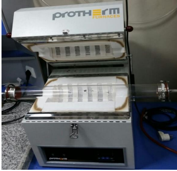
Şekil 3.5. İGO-Cu 75 Pd 25 katalizörlerinin 400°C’de Ar-H 2 (%5H 2 ) gaz karışımı akışında tavlama sisteminin gerçekleştirildiği fırın sistemi
