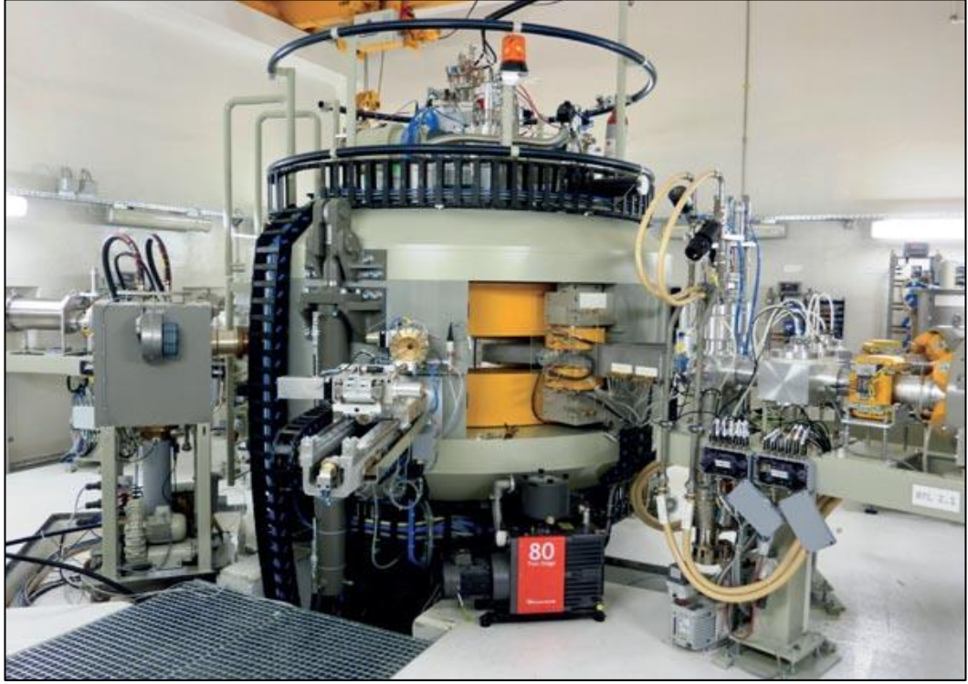
Şekil 2.2. 30 MeV'lik bir siklotron (Anonymous 2015b)
