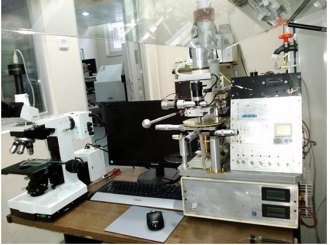
Şekil 3.6. Fotolitografi işlem için hizalama ve pozlandırma cihazı *Atatürk Üniversitesi, Mühendislik Fakültesi, Nanoteknoloji Laboratuvarı
