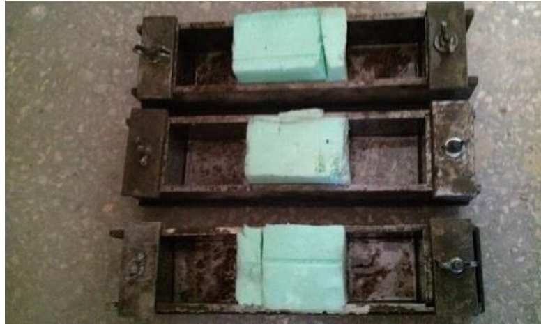
Şekil 3.9. Betonların konulduğu kalıplar
