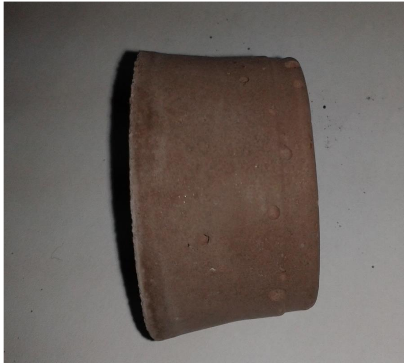
Şekil 4.23. Galena ve bor karbit beton numunesi
