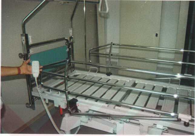
Resim 15: Yatağın tüm hareketleri bir elektrik motoru sayesinde kumanda apereyi ile yapılabilmektedir. Önemli bir özelliği de yatağın tamamen yıkanabilmesi ve elektrik aksamına buna göre hazırlanmış olmasıdır.
