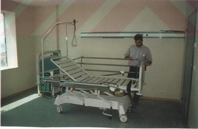
Resim 16: Hasta yatağının oturma pozisyonu; sırt kısmı farklı açılarda daha dik veya daha yatay olabilir.
