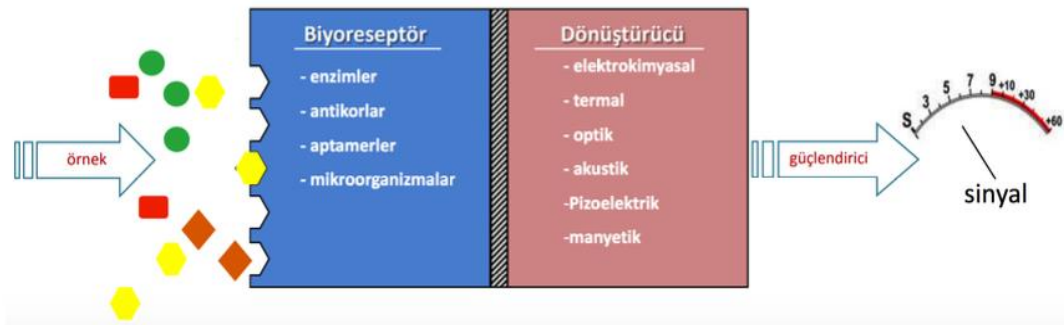
Şekil 2.2. Biyosensörlerin genel çalışma mekanizması.
