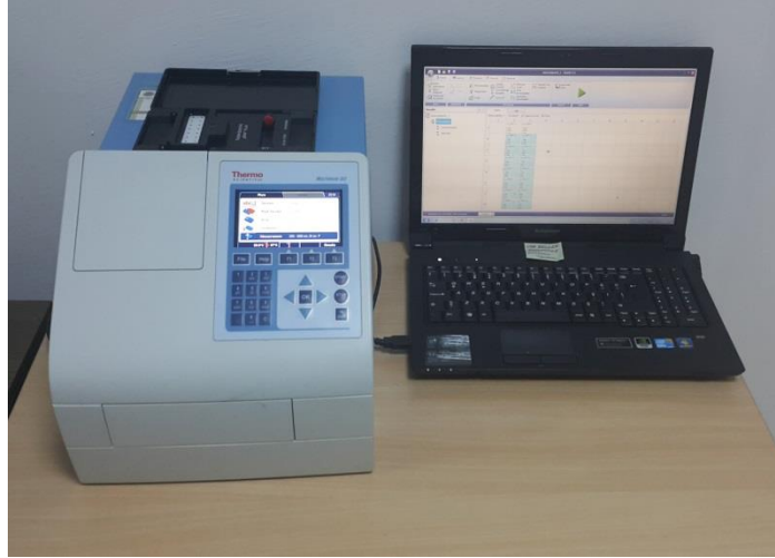
Şekil 3.6. Araştırmada kullanılan \mu Drop™ Plate nanodrop spektrofotometre
