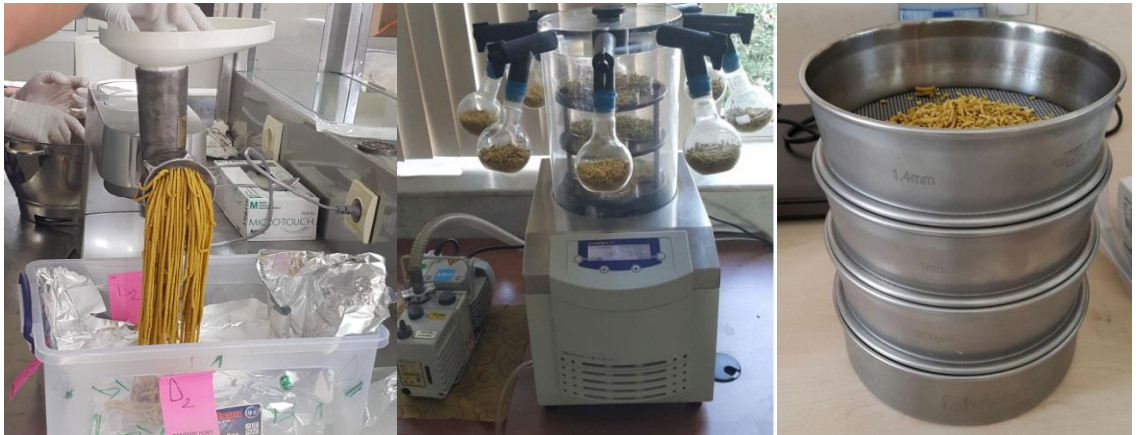
Şekil 3.3. Araştırmada kullanılan yemlerin pelet haline getirilmesi, liyofilize edilmesi ve 1400\mu , 1000\mu , 800\mu 'luk eleklerden geçirilmesi
