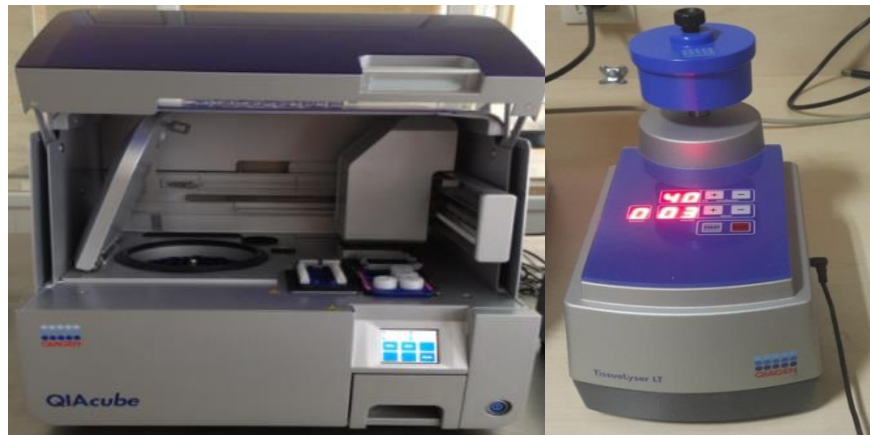
Şekil 3.5. Araştırmada RNA izolasyonunda kullanılan QIACUBE otomatik izolasyon robotu. Araştırmada dokuların parçalanmasında kullanılan Tissuelyser LT
