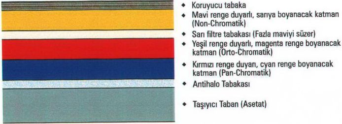
Şekil –8: Renkli Reversel Film Kesiti
