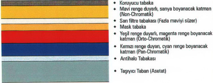
Şekil -11: Renkli Negatif Film Kesiti
