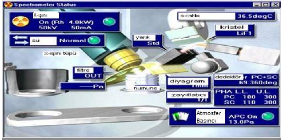
Şekil 3.5. WDXRFS'nin şematik gösterimi
