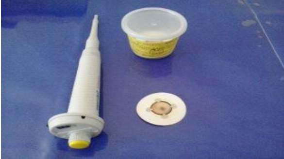
Şekil 3.6. Rigaku filtre kağıdı ve enjeksiyon aleti
