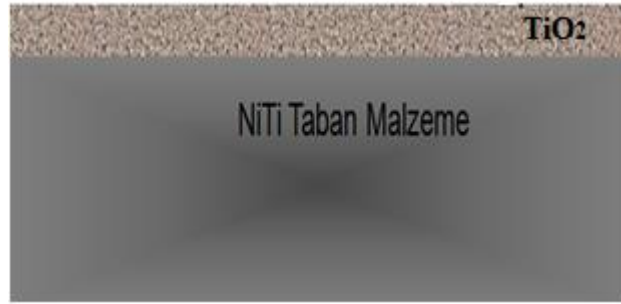
Şekil 3.2. NiTi alaşımı üzerine TiO 2 büyütilmesi
