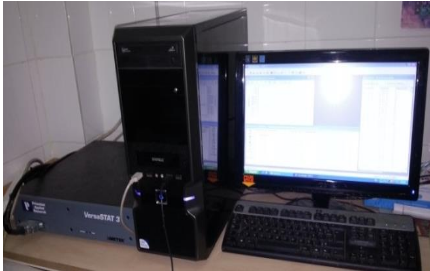
Őekil 3.6. Korozyon ünitesi
