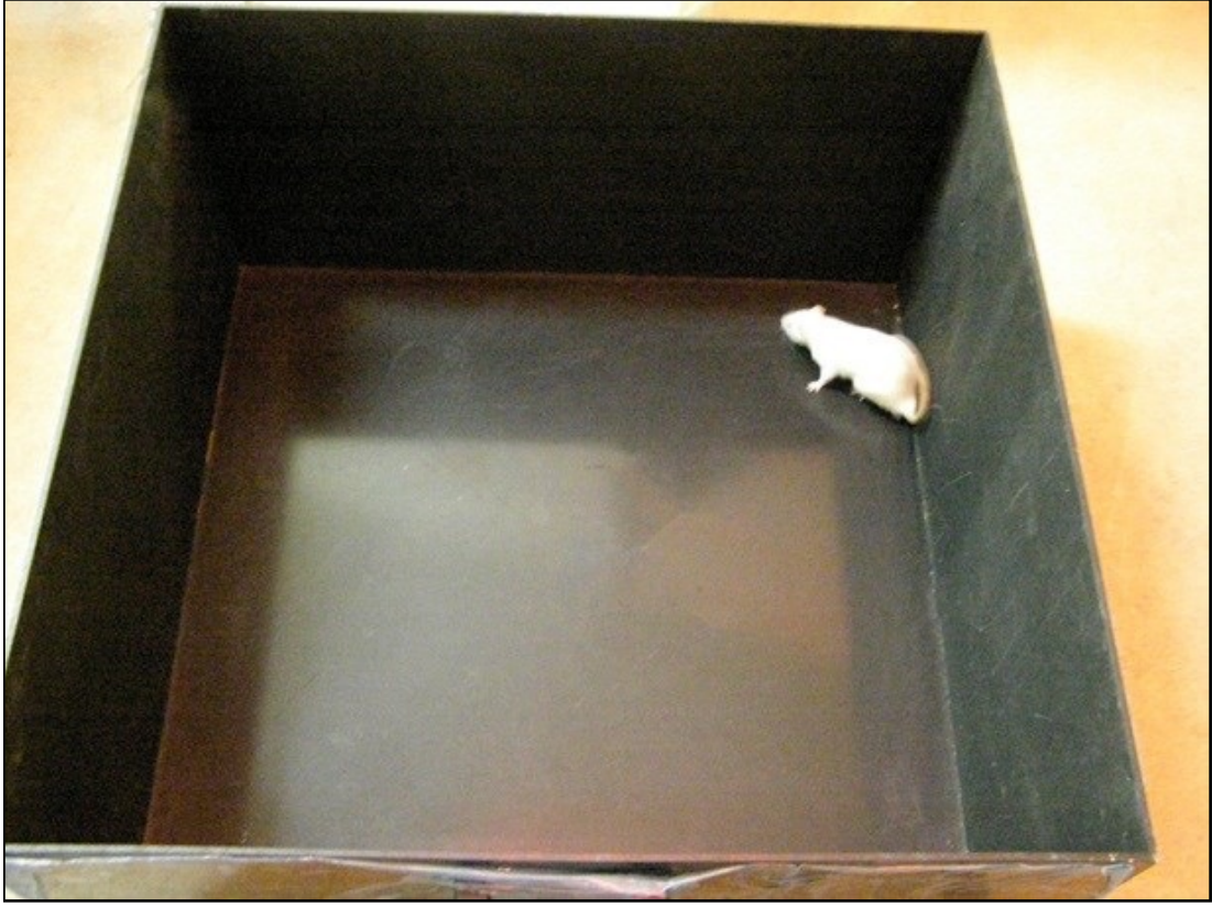
Şekil 3.6.1. Açık alan testi için kullanılan 45 x 45 x 30 cm ölçülerinde siyah kutu.
