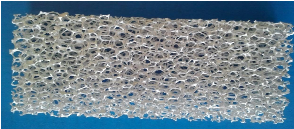
Şekil 3.10. Deney sisteminde kullanılan alüminyum köpük kanatların görünüşü, kanat gözenek yapısı a) P=10, b) P=20, c) P=40 (inç başına geçirgenlik)
