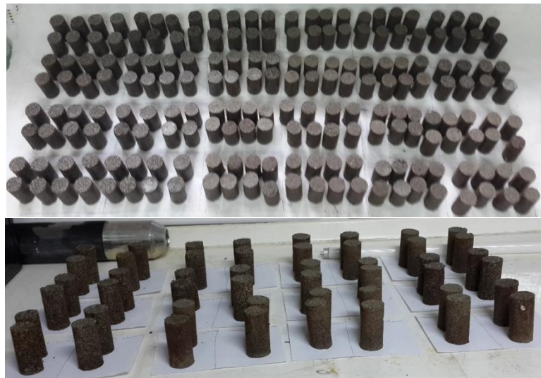
Şekil 3.9. Kür odasında bekletilen kum-biyopolimer numuneleri
