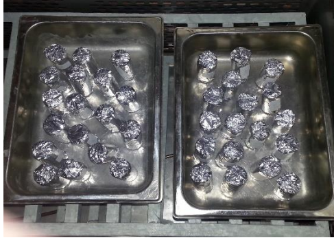
Şekil 3.11. Donma-çözülme cihazında bekletilen alüminyum folyo içerisindeki numuneler
