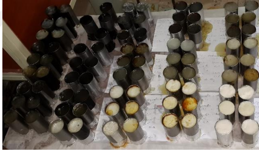
Şekil 3.6. Sabit sıcaklıkta hazırlanan biyopolimer-su karışım numuneleri
