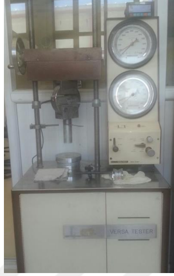
Şekil 3.10. Serbest basınç mukavemeti deneylerinde kullanılan SoilTest cihazı
