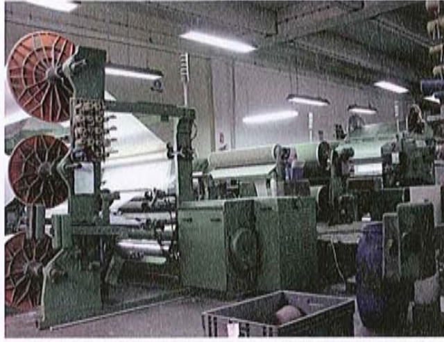
Fotoğraf 94: Çift katlı düz kadife dokuma tezgahı. Epengle Tekstil A.Ş., Sultan ERDOĞAN 2007
