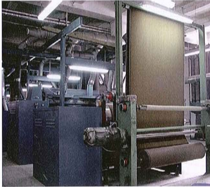
Fotoğraf 113: Dokunmuş kadife kumaş bitim işlemlerine girerken. Epengle Tekstil A.Ş., SULTAN ERDOĞAN 2007
