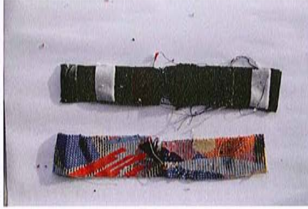
Fotoğraf 121: Kadife kumaşta kopma mukavemetini gösteren örnekler. Epengle Tekstil A.Ş., SULTAN ERDOĞAN 2007
