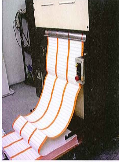
Fotoğraf 112: Otomatik Jakar katon delim makinesi detayı. Epengle Tekstil A.Ş., SULTAN ERDOĞAN 2007
