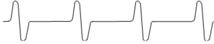
Şekil 3.14. Krank mili sensöründen alınan sinyal biçimi
