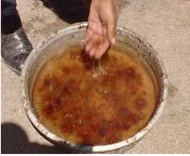
Resim90: Nişeleme işleminde kullanılan haşıl maddesi
