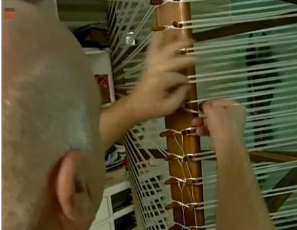
Resim78: Bağlık ipliklerinin bağlanması
