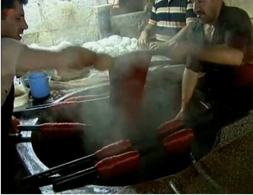
Resim86: İpliklerin boyadan çıkarılması
