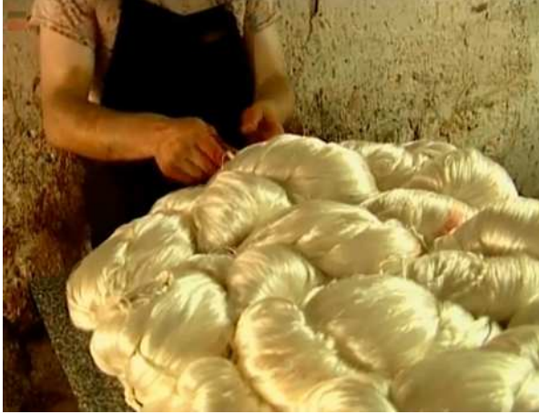
Resim81: Çözgü ipliklerinin boyanması için çilelerinin açılması
