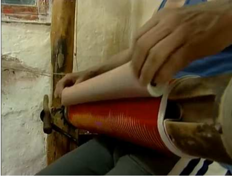
Resim100: Dokuması biten kumaşın makineden alınması
