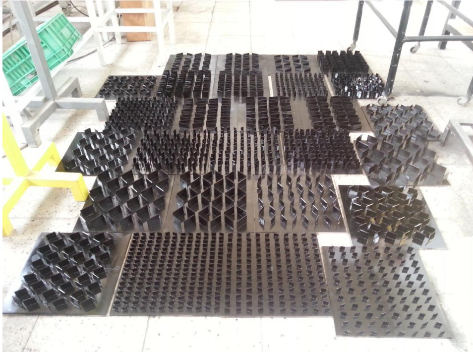
Şekil 4.2. Taguchi L_{27}(3^{11}) deney planına göre hazırlanan test elemanları
