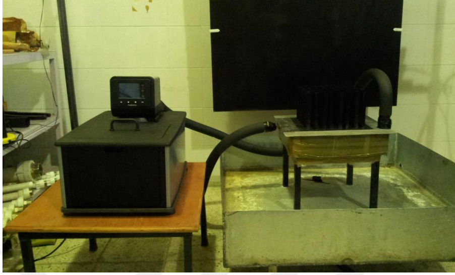
Şekil 3.7. PolyScience kapalı devre su/yağ banyosunun görünüşü (15 litre)
