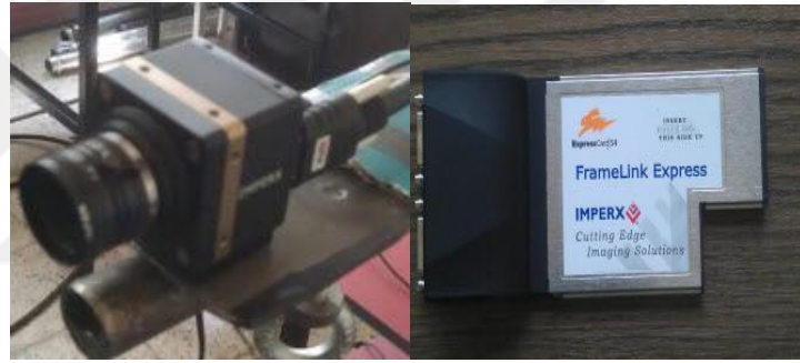
Şekil 3.5. Framelink ve IMPERX ICL-B0620 CCD kameranın görünüşü
