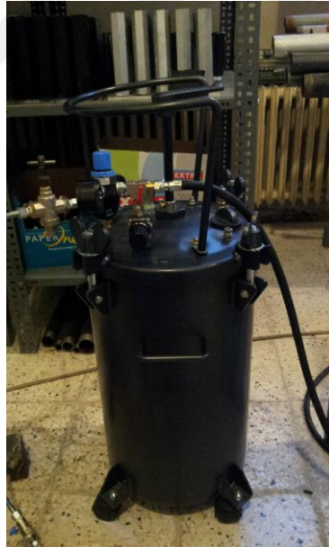
Şekil 3.3. Basınç tankının görünüşü (40 litre)
