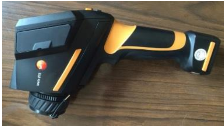
Şekil 3.6. Testo FC-875-2 model termal kameranın görünüşü
