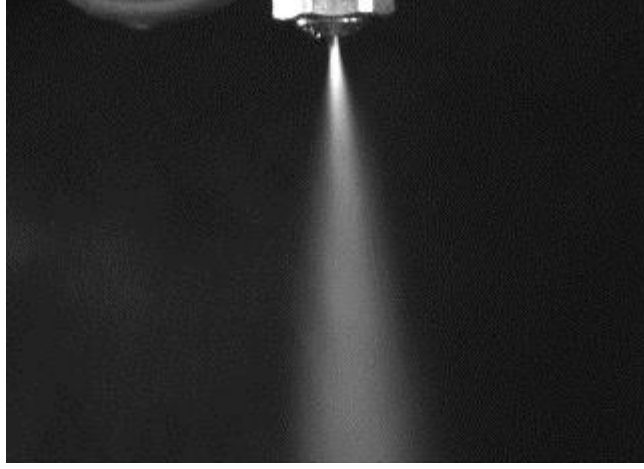
Şekil 4.67. ALR=0,206 için sprej görüntüsü ( Q_a=3,6 \text{ m}^3/\text{h} , Q_l=0,35 \text{ l/dk} , P_a=2,1 \text{ bar} , P_l=1,3 \text{ bar} )
