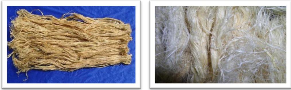
Resim 4.1: İşlenmemiş, ince ve tekstilde kullanılan doğal bambu lifleri
