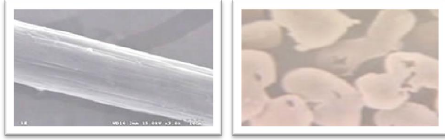
Resim 9.1: Süt lifinin enine ve boyuna kesit görüntüleri
