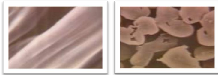
Resim 6.2: Soya lifinin enine ve boyuna görüntüleri
