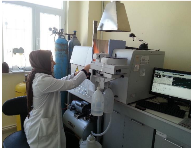
Şekil 3.21. Atomik absorpsiyon spektrofotometresinde iyonların belirlenmesi
