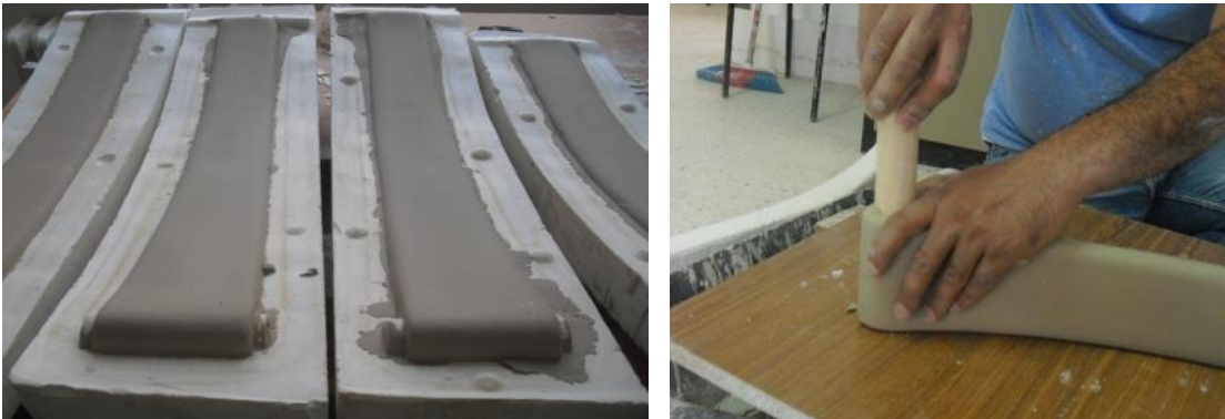
Şekil 44: Kalıp Açma ve Kalıptan Çıkarma İşlemi
