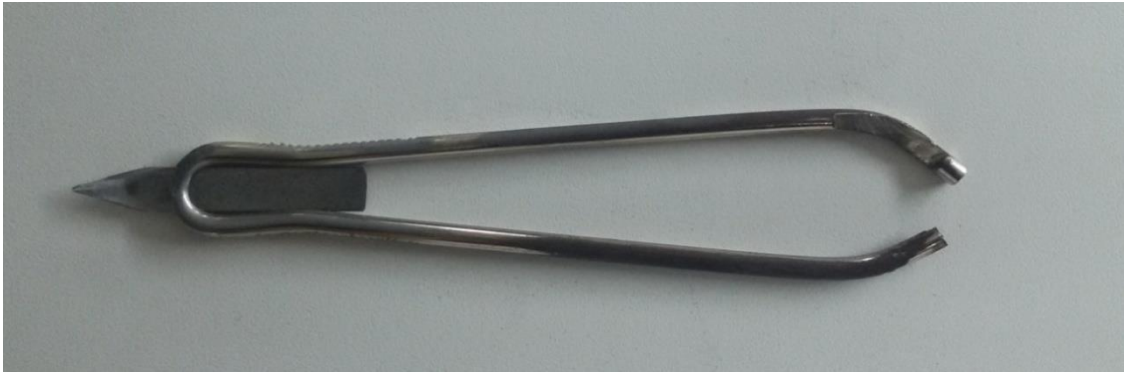
Resim 153: Sap Kısmından Açılarak Körelen Bıçak Değiştirilmektedir
