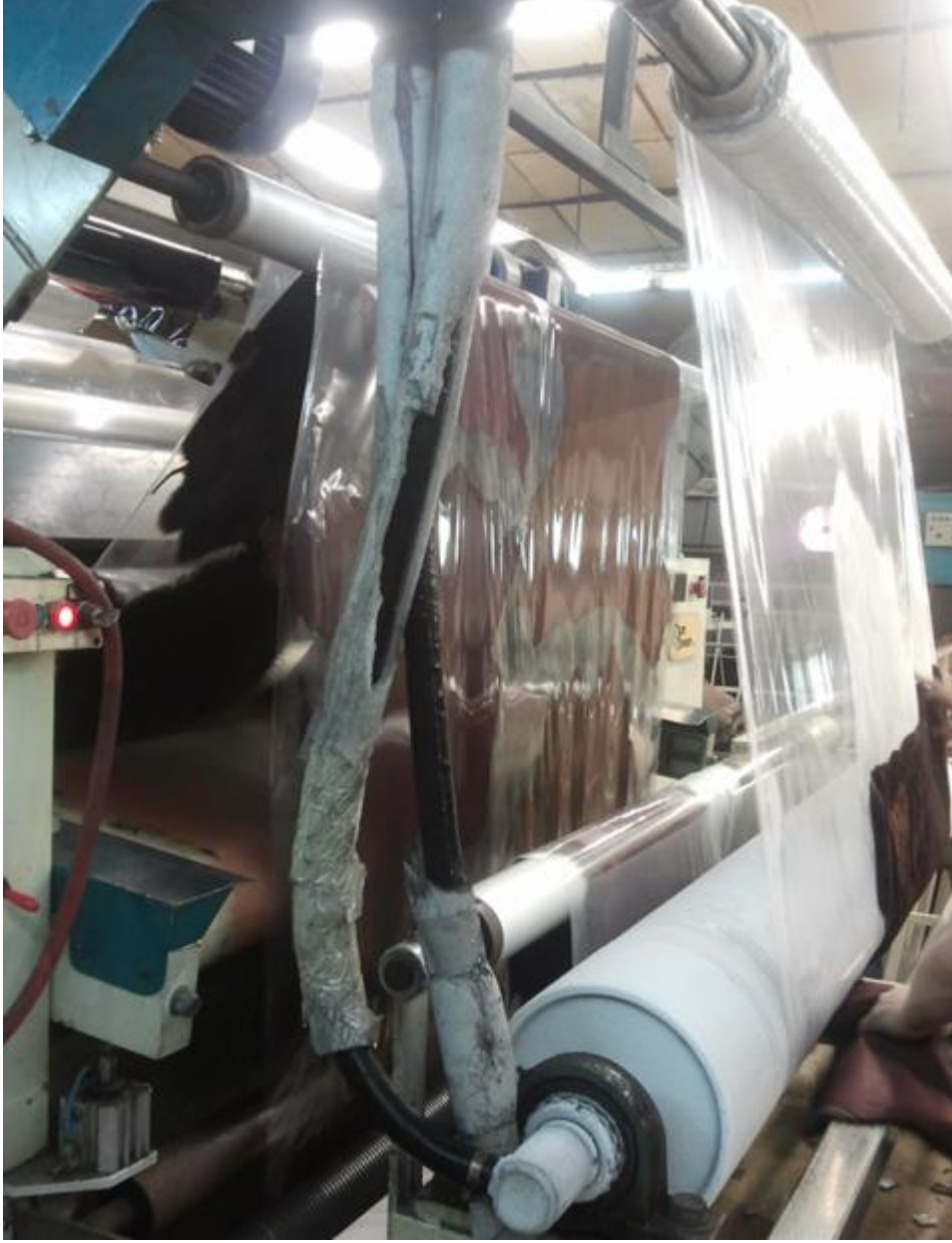
Resim 31: Kâğıt Baskı Makinesinde Deriler Baskı Deseni Olan Yüzeye Basınç ve Isı ile Yapışarak Silindirler Arasından Geçer
