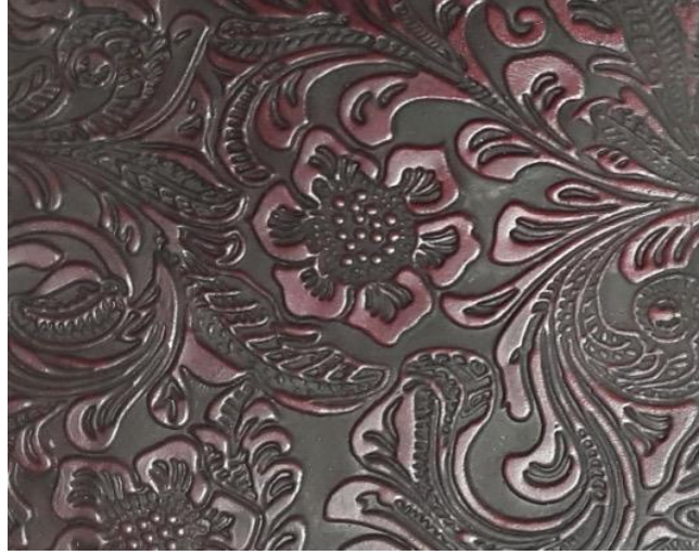
Resim 28: Plaka Baskı. Baskıya Hazırlanan Yüzeye Belli Bir Isı ve Basınç Altında İstenilen Desende Baskı Yapılabilmektedir
