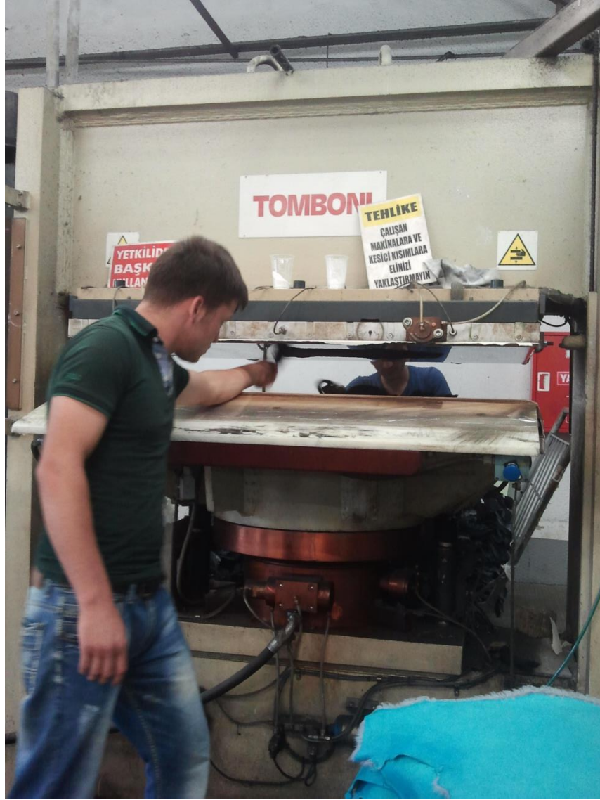
Resim 27: Baskı için kullanılan Hidrolik-Pres Makinesi ile Uygulama Yapılırken,Deri Açık Alana Yerleştirilir ve Üst Bölme Belli Bir Basınç ile Derini Üzerini Kapatır. Bu Makine Düz ve Baskılı Plakaların Deri Yüzeyine Isı ve Basınç Yardımı ile Uygulanmasını Sağlar
