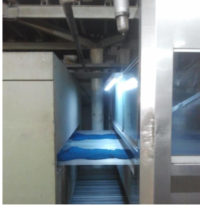
Resim 23: Deri Pistole ile Boyanarak Zeminde Hareket Eden Teller Yardımı ile İlerler
