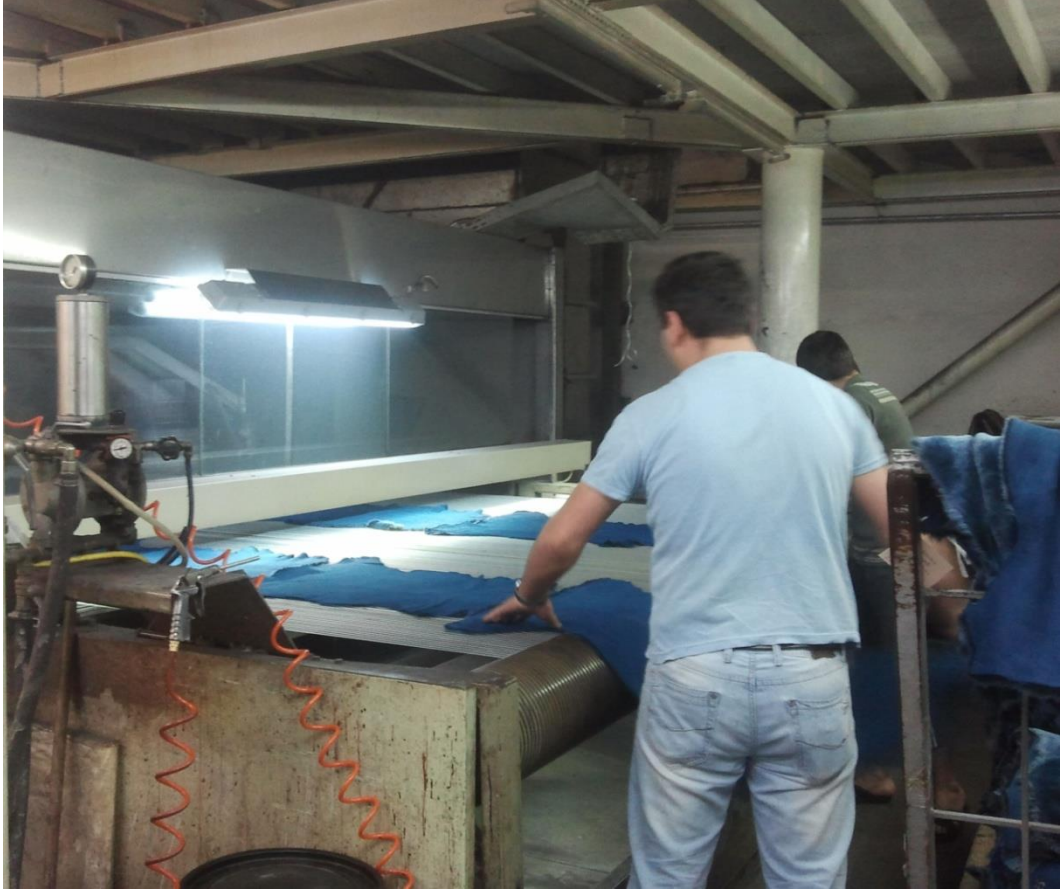
Resim 22: Deri Yüzeyin Pistole Yardımı ile Boyanması için Deriler Makineye Yerleştirilir
