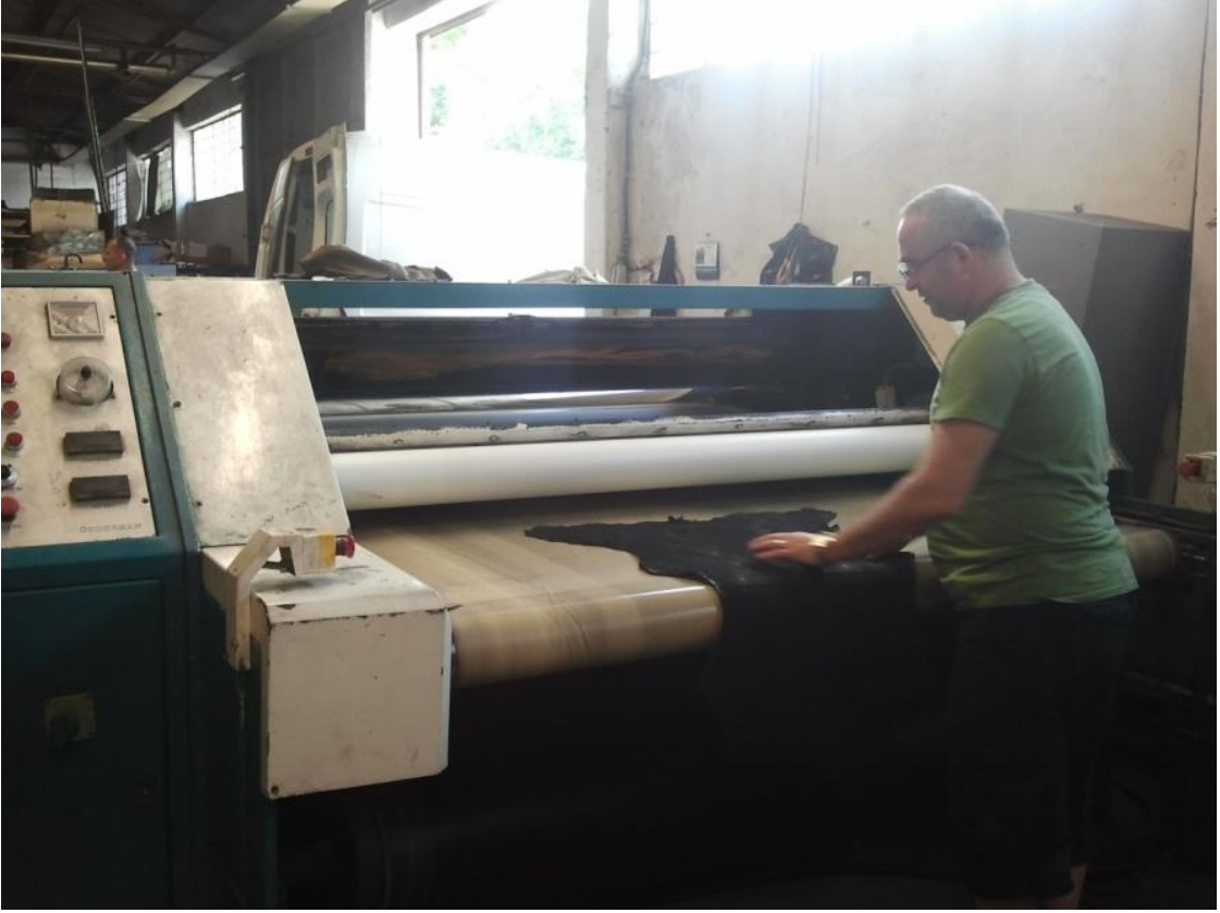
Resim 21: Deri'ye Basınç ile Sürtünme Olayının Uygulandığı Derinin Düzgünleştirilmesi ve Ütülenmesi Esasına Dayalı Olan Makinedir
