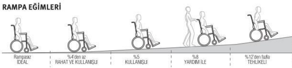
Şekil 23:Rampa eğimleri ve kullanımı
