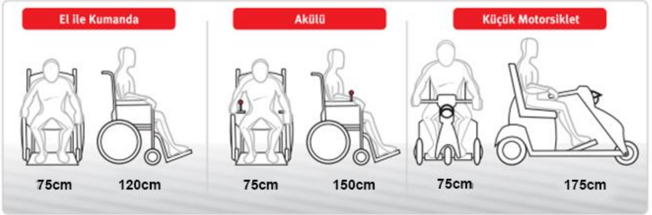
Şekil 7:Engelliler Tekerlekli Sandalye ve Motorsiklet Ölçüleri
